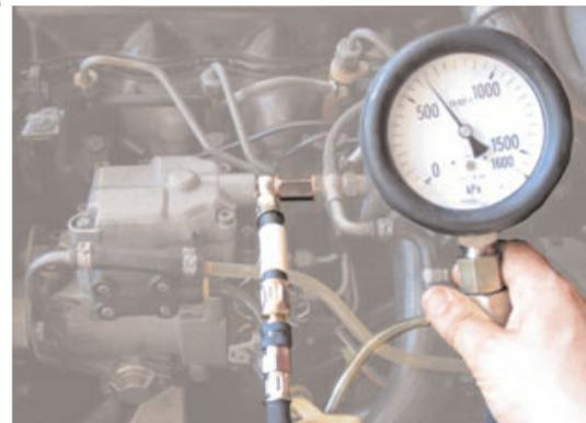
Förderpumpendruck, bzw. Innenraumdruck
