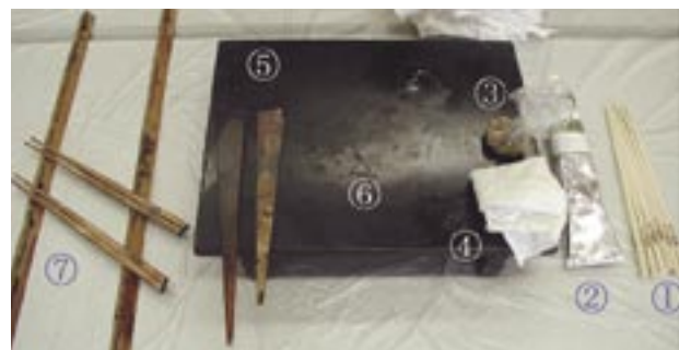
①箸(白木地) ②生漆 ③水漆※ ④ウエス ⑤ヘラ ⑥定盤 ⑦拭き漆後の箸
