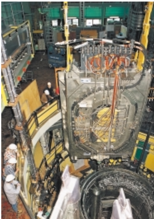
Test der supraleitenden ITER-Modellspule im Forschungszentrum Karlsruhe
