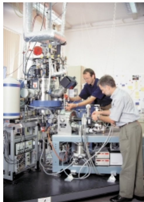
Mit der Ionenfalle EBIT werden hochgeladene Ionen erzeugt und untersucht
