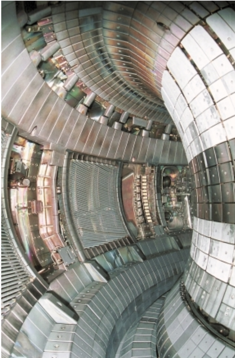
Blick in das Plasma- gefäß von ASDEX Upgrade. Die dunklen Graphitziegel sind mit Wolfram beschichtet.
