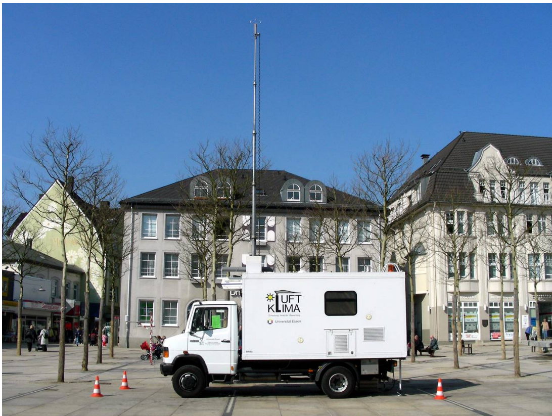
Abb. 2-3 Mobiles meteorologisch-lufthygienisches Messlabor der Abteilung Angewandte Klimatologie der Universität Duisburg-Essen. Messgrößen: Lufttemperatur, Luftfeuchtigkeit, Wind, Luftdruck, UV- und Globalstrahlung, NO, NO 2 , CO 2 , O 3 , VOC, PM x (Foto: Ptak/Nekes)
