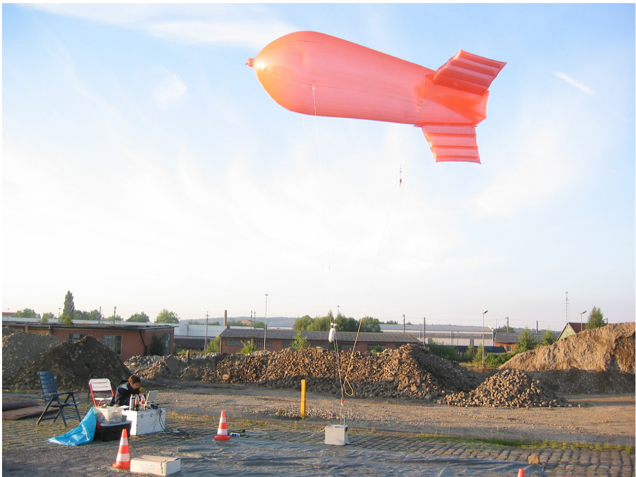
Abb. 2-4 Fesselballonsonde zur klimatologischen Untersuchung der vertikalen Struktur der bodennahen Atmosphäre (Foto: Düttemeyer)
