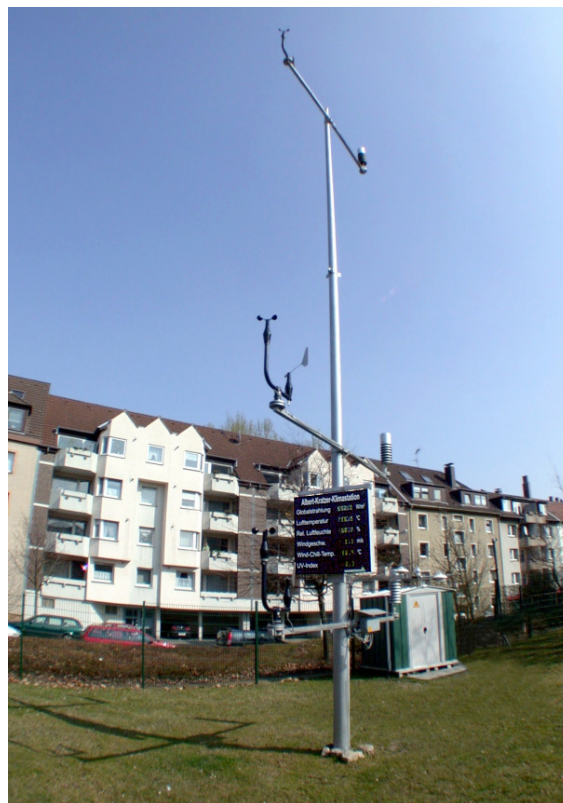
Abb. 2-2 Klimastation zur Erfassung von Lufttemperatur, Luftfeuchtigkeit, Windrichtung und – geschwindigkeit sowie verschiedenen Energiebilanzglieder in unterschiedlichen Messhöhen an der Albert Kratzer Klimastation der Universität Duisburg-Essen in Essen (Foto: Kuttler)
