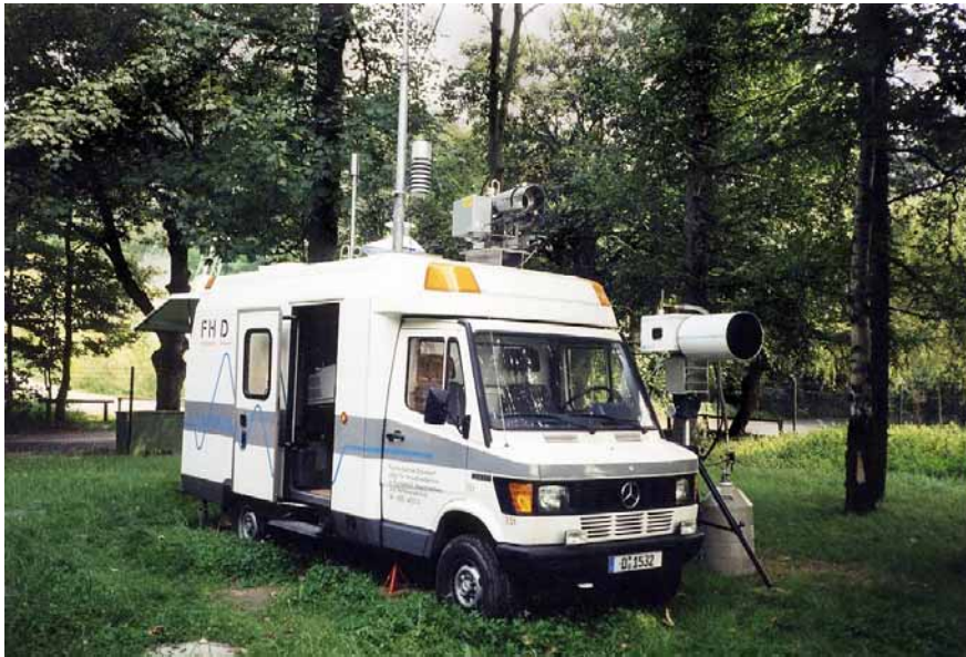
Abb. 2-7 Optische Fernerkundungssysteme DOAS (auf dem Fahrzeug) und FTIR (neben dem Fahrzeug) zur wegstreckenintegrierten Erfassung lufthygienischer Komponenten (Foto: Lamp)
