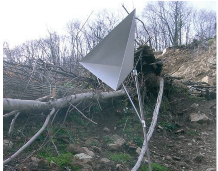
Fig. 11 - Corner reflector utilizzato per la georeferenziazione della mappa radar - Corner reflector used for georeferencing the radar map
