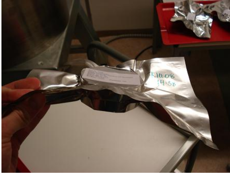
Kuva 6. Vakumoitu sedimenttinäyte. Näyteastia (100 ml) on kuvan keskellä alumiinisen pussin sisällä.
