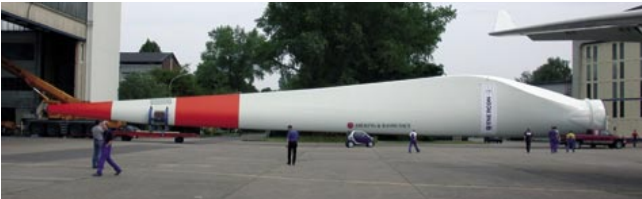
Abb. 3: Um den Energiebedarf für die Herstellung der riesigen Rotorblätter aus glasfaserverstärktem Kunststoff zu ermitteln, müssen die Forscher den Anteil jedes einzelnen Bestandteils wie Epoxidharz, Härter, Glas und Lack und ihre spezifischen Energieverbräuche kennen.
