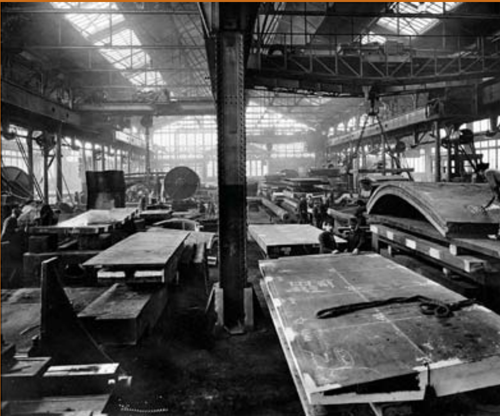
Le Creusot, atelier d'ajustage de blindages et atelier de finissage des blindages de navires © Boyer / Roger-Viollet
