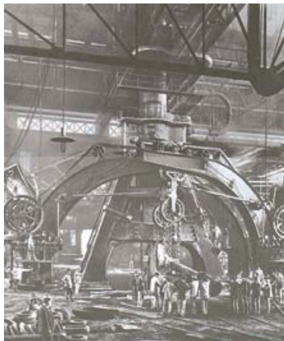
Le marteau-pilon de 100 tonnes, en service au Creusot de 1875 à 1930 archives Schneider.
