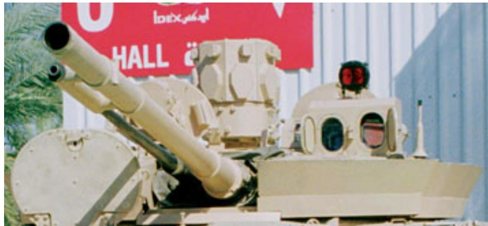
**Башня модернизированной БМП-3 с прицельным комплексом «Весна-К» и системой активной защиты «Арена-Э»**
