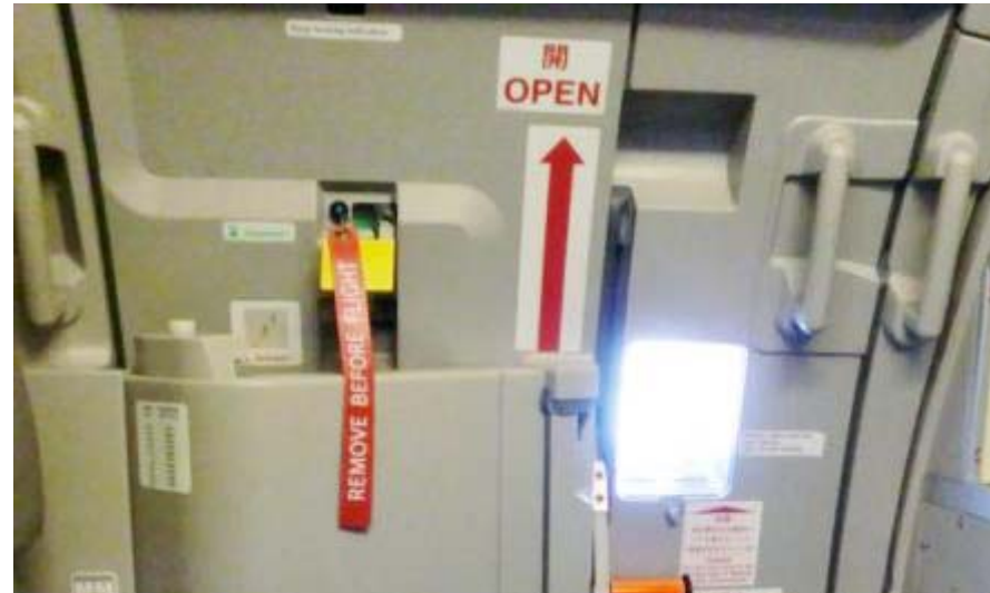
飛行機のドアの動作モード管理（鍵ストラップ）
