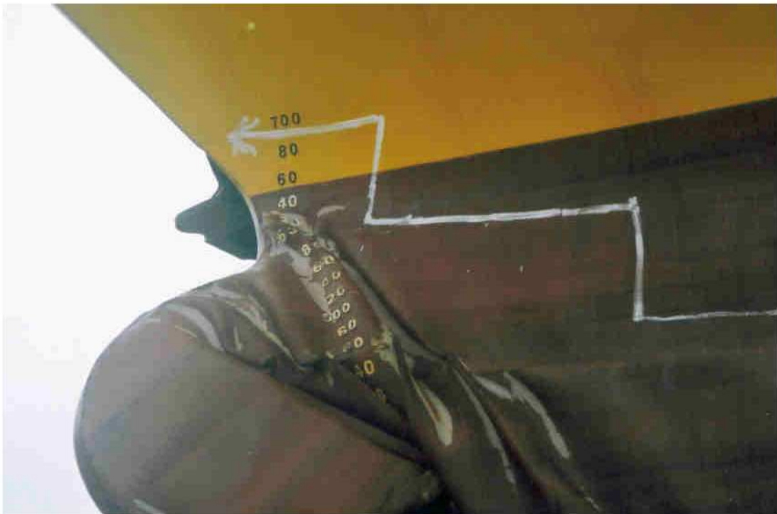
Vue du bulbe déformé.
