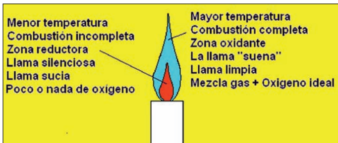
Figura 1. Características de la llama según la proporción de gases en la mezcla.
