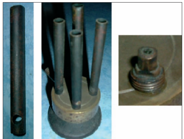
Figura 11. Mechero Bunsen de cuatro tubos con una base común; la entrada del aire se regula girando los tubos (Foto de la izquierda) sobre una base concéntrica fija (Foto de la derecha) de manera similar al Bunsen clásico. Su función sería la de calentar superficies amplias de manera similar al Mecker.
