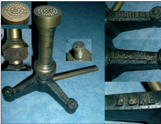
Figura 8. Mechero Mecker (Museo del Instituto de Medicina Preventiva). A: Boca cribada. B: Malla metálica de entrada de aire. C: Doble espita de salida de gas. A la derecha se pueden apreciar las inscripciones de las tres patas del fabricante alemán de este ejemplar.
