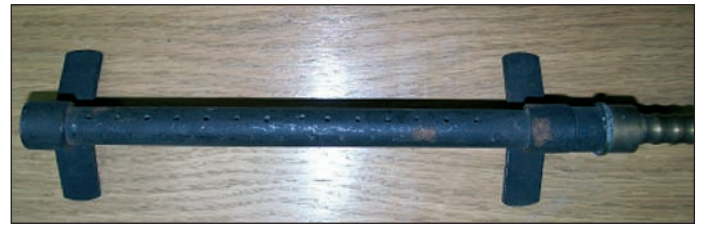
Figura 10. Mechero alargado con una fila de espitas en el tubo en forma de simples orificios. La mezcla se hace por una apertura en el principio del tubo. Probablemente su función fuera calentar conducciones de vidrio.
