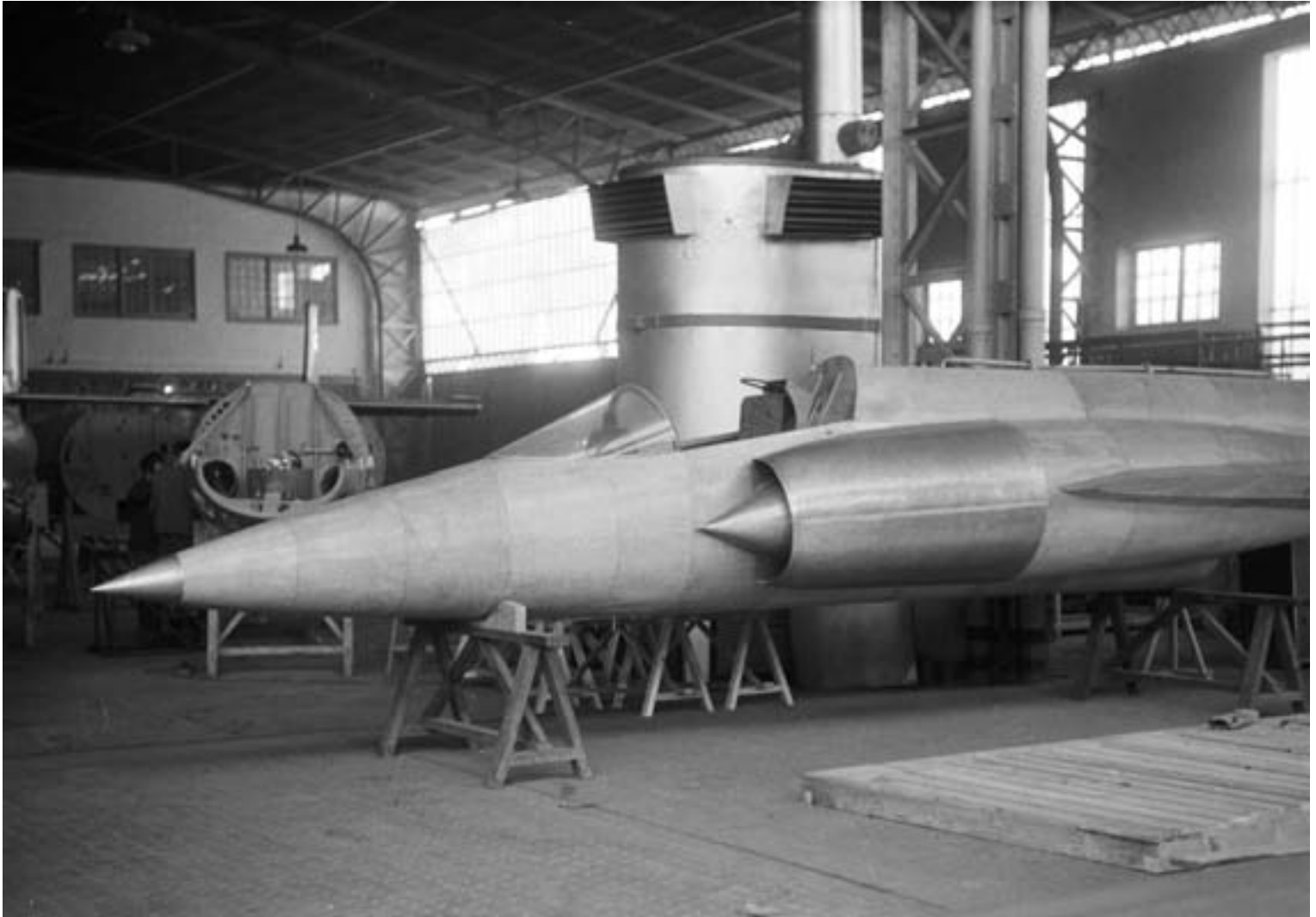
La maqueta a escala natural de la configuración final del HA-300 parcialmente construida (febrero de 1960).
