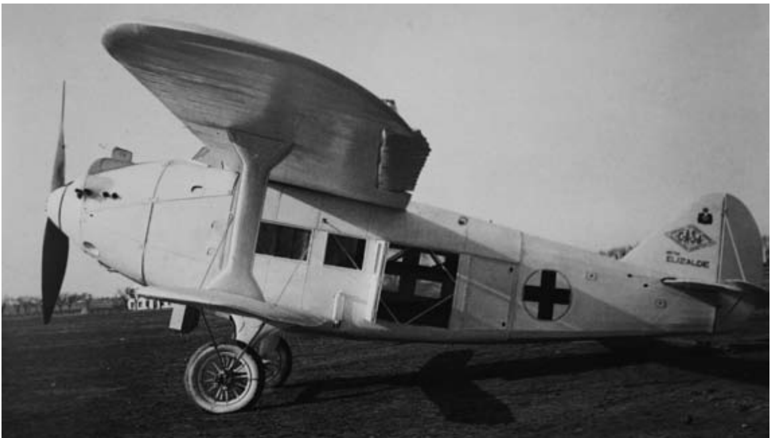
Uno de los dos Breguet 26T fabricados por CASA y que era la versión sanitaria del Breguet XIX.
