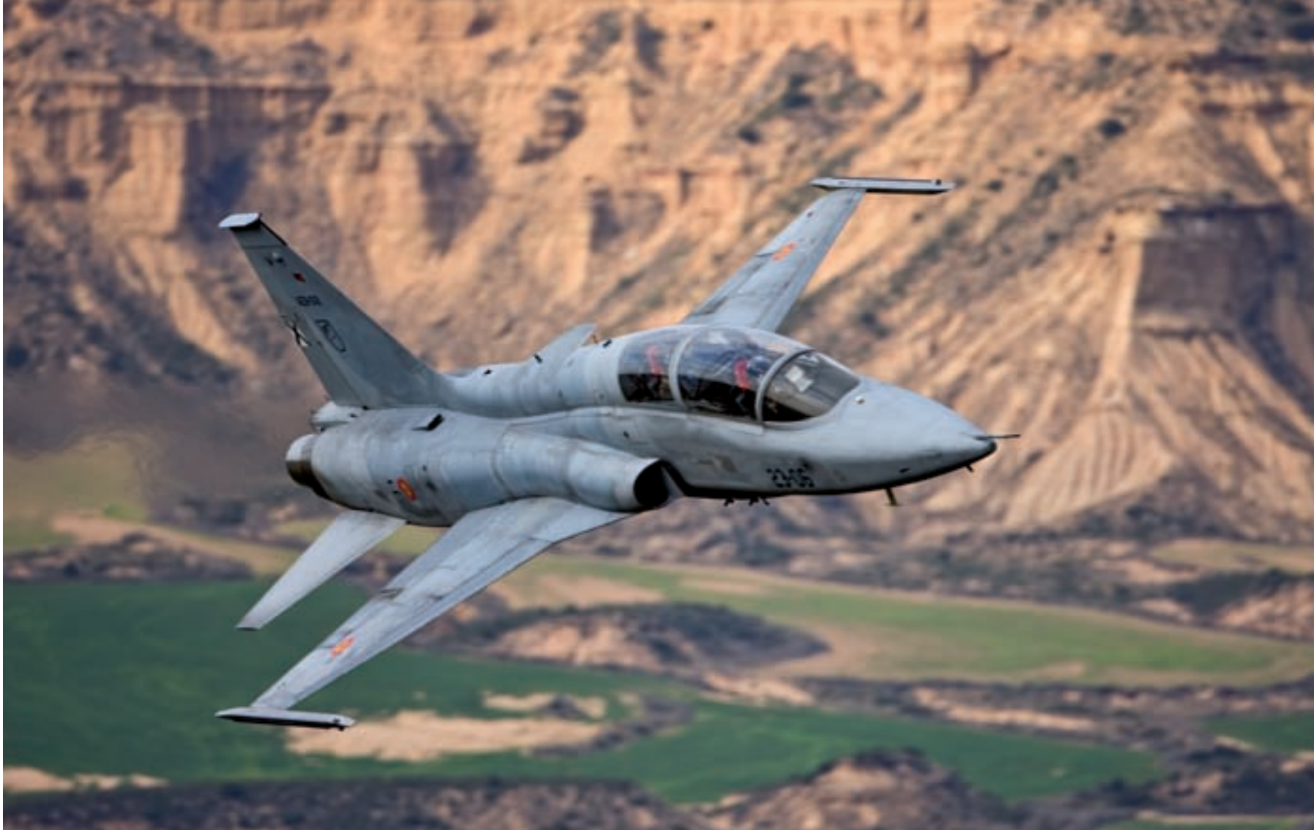
El reactor F-5 de la empresa Northrop, fue fabricado por Construcciones Aeronáuticas en sus dos versiones F-5A monoplaza y F-5B biplaza. Las primeras unidades fueron entregadas en junio de 1969. Este excelente avión táctico y de enseñanza estuvo en servicio en las bases aéreas de Morón y Gando y en la Escuela de Reactores de Talavera, continuando hoy día en ésta última tras una amplia modernización.
