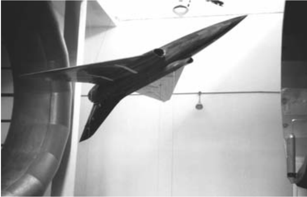
Maqueta del HA-300 ensayada en el túnel aerodinámico del INTA (14 de junio de 1954). La configuración ensayada entonces respondía a la de un caza de superioridad aérea e interceptación equipado con un SNECMA ATAR 101E de 3.500 kg de empuje; la envergadura era 7,4 m, la superficie alar 24,62 m 2 y la longitud 13,11 m. El peso máximo de despegue calculado era de 5.000 kg y la velocidad máxima estimada era de 1.400 km/h.
