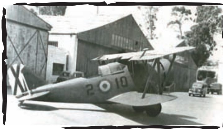
De los nueve Grumman GE-23 que habían servido en la aviación republicana y fueron puestos en vuelo y utilizados por el Ejército del Aire, el R.6-2 (ex 5W-2) fue uno de los cuatro a los que, a comienzos de los años cincuenta, les fueron instalados motores rusos M-25 en los Talleres de Tetuán (SHYCEA).
