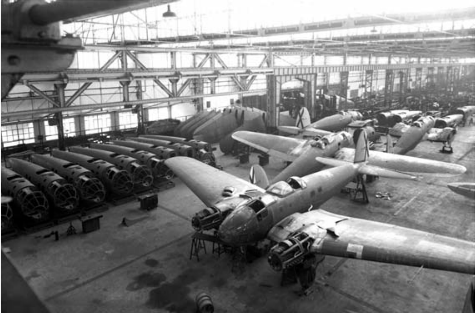
Cadena de montaje de los C-2.111 en la factoría de Tablada de CASA.
