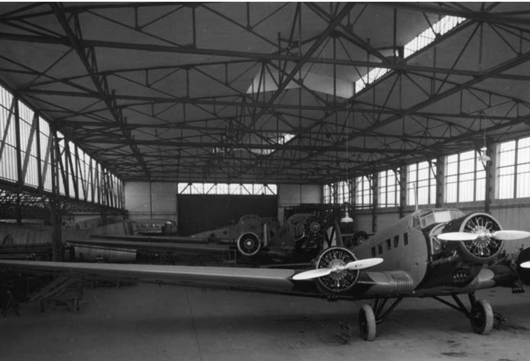
Línea de producción del C-352 en la factoría de Getafe de CASA. Avión en proceso de pesada previo a su salida a línea de vuelo. Foto fechada el 3 de febrero de 1948.
