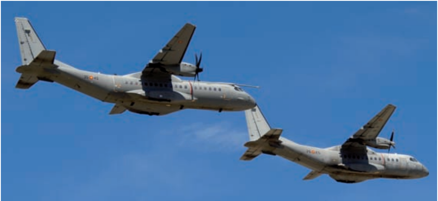
En la imagen se aprecia el diferente tamaño del fuselaje entre el C-235 y el C-295.
