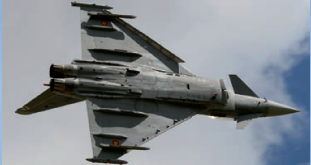
Sus mandos eléctricos, diseño y potencia motriz hacen del EF-2000 un caza "superágil" con prestaciones en algunos casos limitadas para adecuarlas a la fisiología del piloto.
