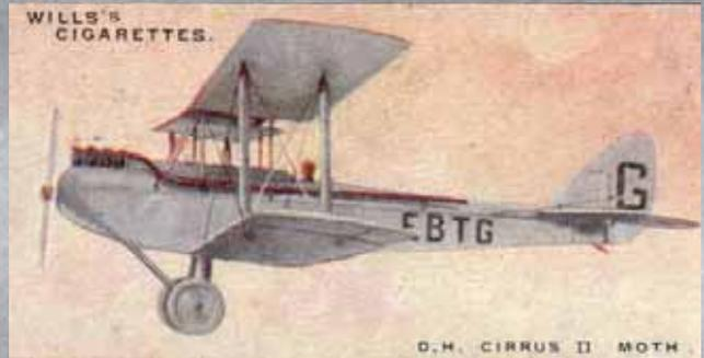
Tarjeta de colección de Will's Cigarettes con la ilustración del segundo DH60 en pleno vuelo. Nótase el puesto retrasado de pilotaje de Mrs. Bailey debido al depósito auxiliar de combustible. (Imperial Tobacco C.O.).
