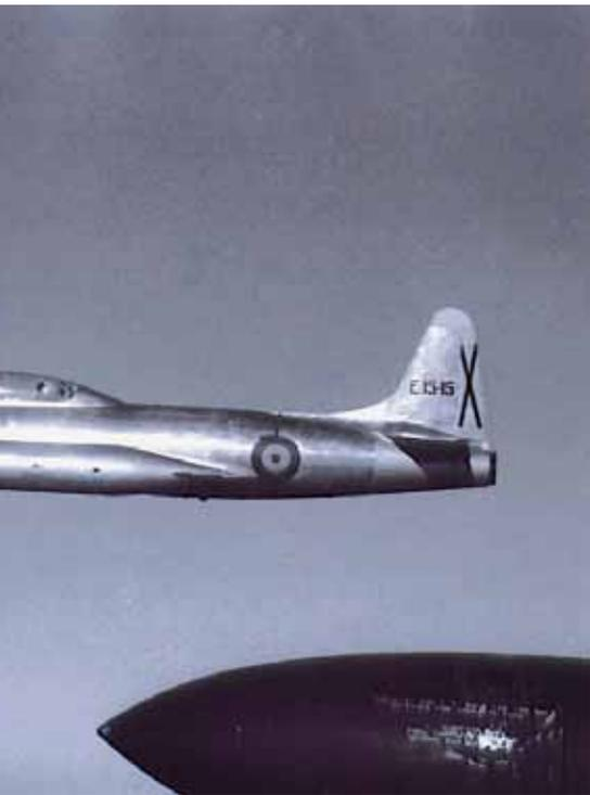
*En esta perspectiva del E.15-40 (73-60) puede apreciarse que todavía no se le ha instalado el TACAN, pues no tiene la antena correspondiente delante de las puertas de la pata delantera del tren. (B.A. Talavera la Real, archivo del autor).*
