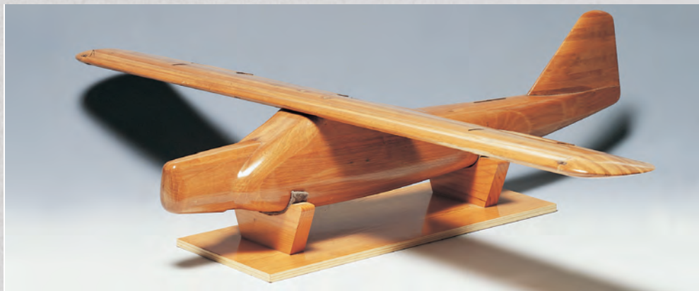
Maqueta de madera de la Do-25 empleada para los ensayos en túnel aerodinámico realizados en el INTA. Se conserva en el Museo del Aire.
