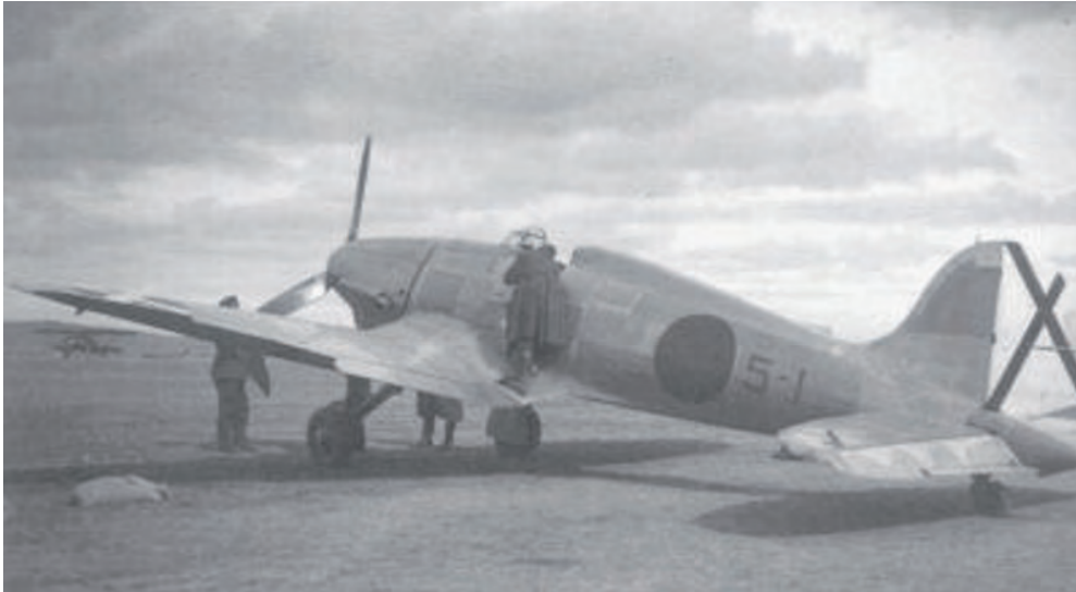
En esta instantánea del He 112 V 3 5-1, sin duda anterior a que ocurriera el incidente mencionado en el texto, puede verse que su hélice era tripala (Vía Günther Ott).
