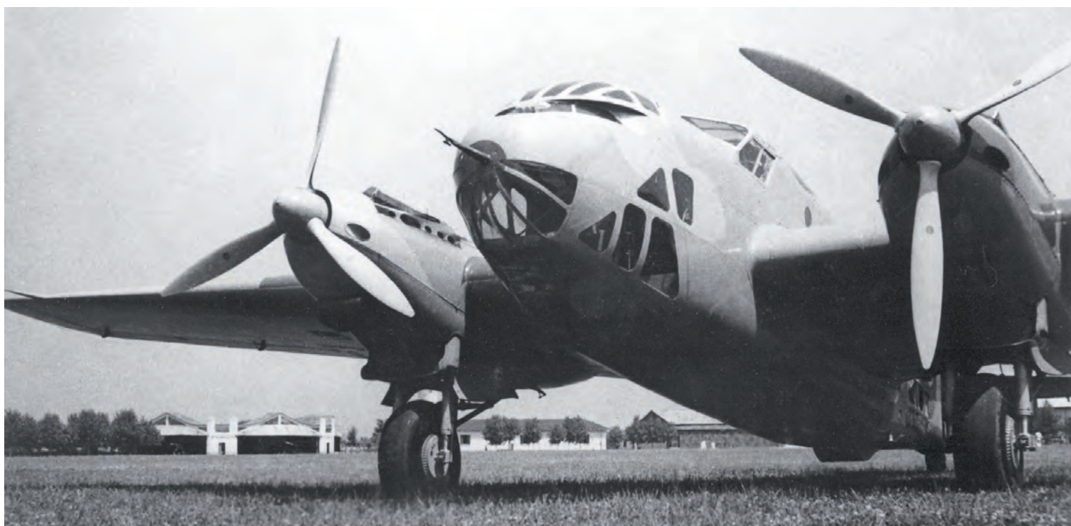
El prototipo del Ca.135 (MM 299), en Taliedo con motores Isotta Fraschini Asso R.C.40 y hélices tripalas de paso variable.
