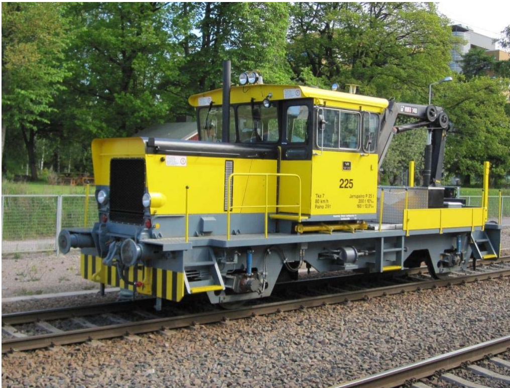
Kuva 2.2 Tka7-ratakuorma-auto, jonka lavalle on asennettu STM:n koemalli.
