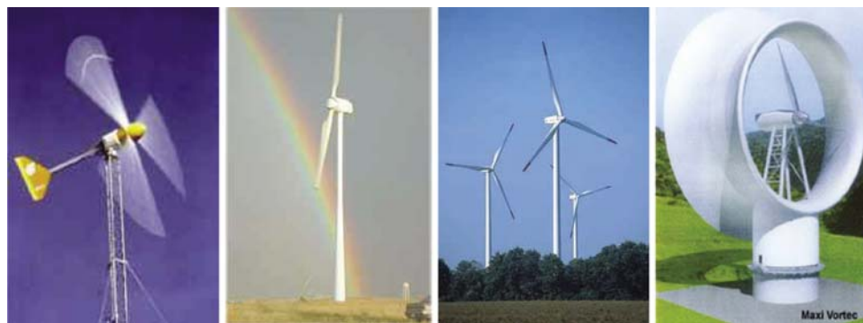
Rys. 3.10. Przykłady siłowni wiatrowych z poziomą osią obrotu: a) mała przydomowa elektrownia wiatrowa o mocy 10 kW BWC Excel [http://www.bergey.com], b) wirnik z dwoma łopatom [http://www.windturbinecompany.com], c) turbiny wiatrowe GE Power na farmie wiatrowej Walchum, Niemcy [http://www.gepower.com], d) turbina wiatrowa firmy Vortec z dyfuzorem DAWT
