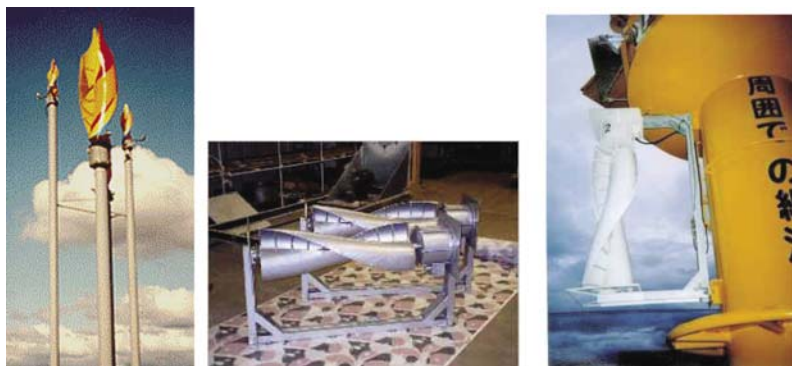
Rys. 3.39. Turbiny „świderkowe”, z powierzchnią roboczą płata ułożoną wzdłuż linii śrubowej [ http://www.windside.com ]
