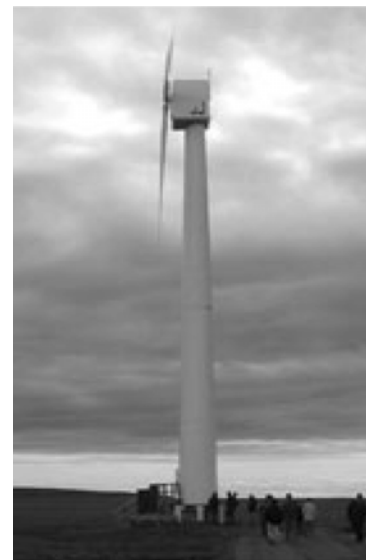
Rys. 3.5. Wirnik typu down-wind
