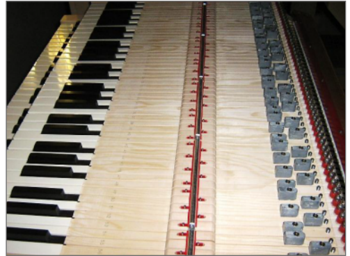
Das zweite Manual: nach dem sichtbaren Teil der Taste ist die Taste noch längst nicht zu Ende!
