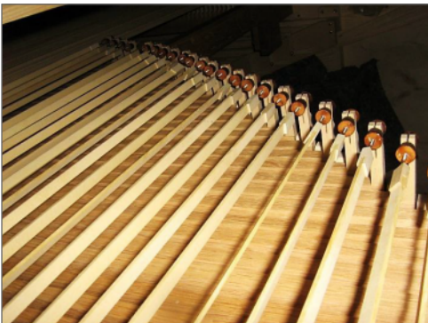
Über Winkel und Abstrakte (schmale Holzleisten) wird die Verbindung der Taste bis zum Ventil hergestellt.
