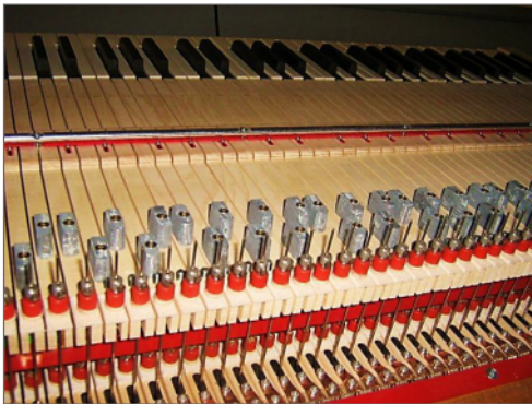
Über Winkel und Abstrakte (schmale Holzleisten) wird die Verbindung der Taste bis zum Ventil hergestellt.
