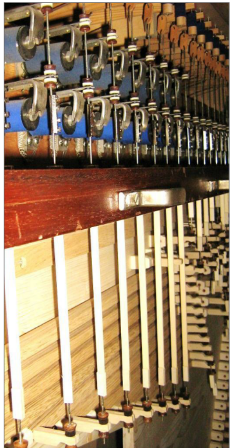
Das zweite Manual: nach dem sichtbaren Teil der Taste ist die Taste noch längst nicht zu Ende!
