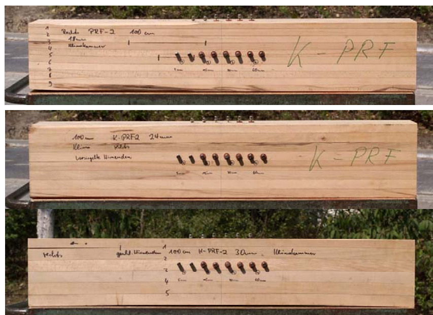
Abbildung 6.15: Balkenabschnitte aus der Klimakammer mit Messelektroden (versiegelte Hirnenden)
