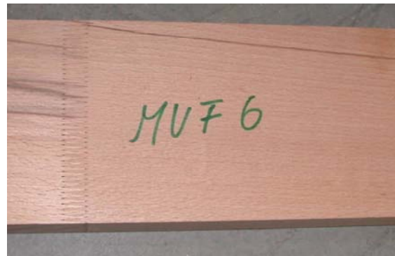
Abbildung 6.46: Holzversagen mit Anriss an der Keilzinkung
