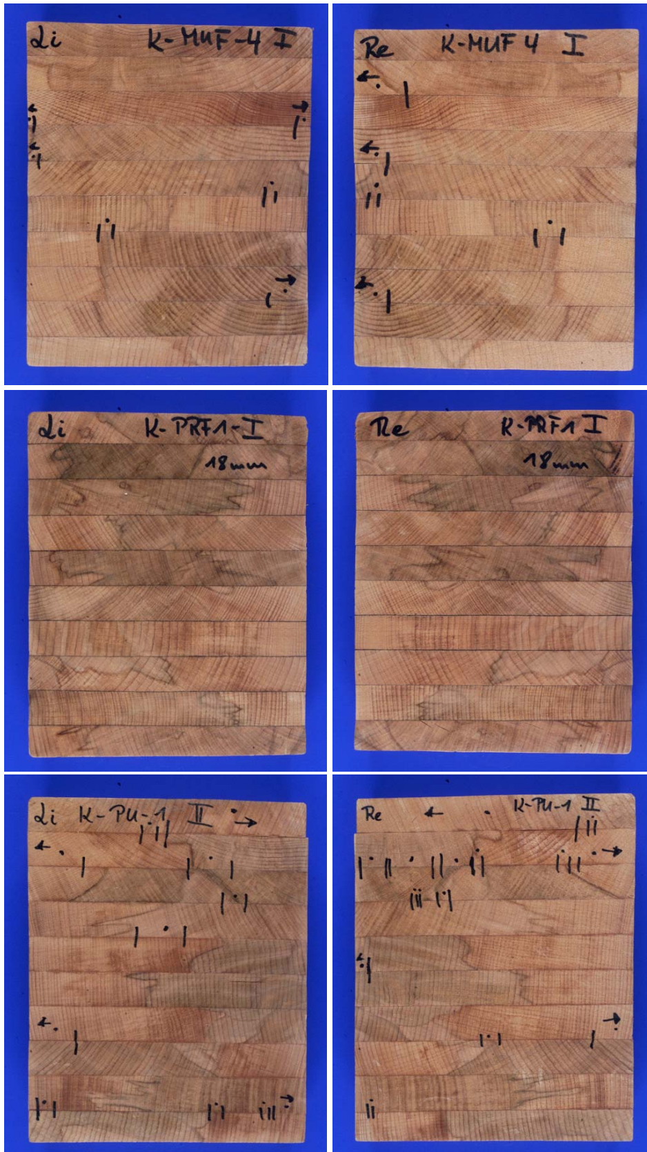
Abbildung 6.6: Delamierte Prüfkörper (Lamellenstärke 18 mm)
