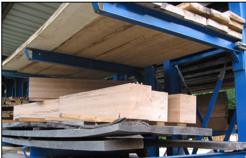
Abbildung 6.13 Klimalagerung – Balkenabschnitte im Freien unter Dach („Holzplatz“)
