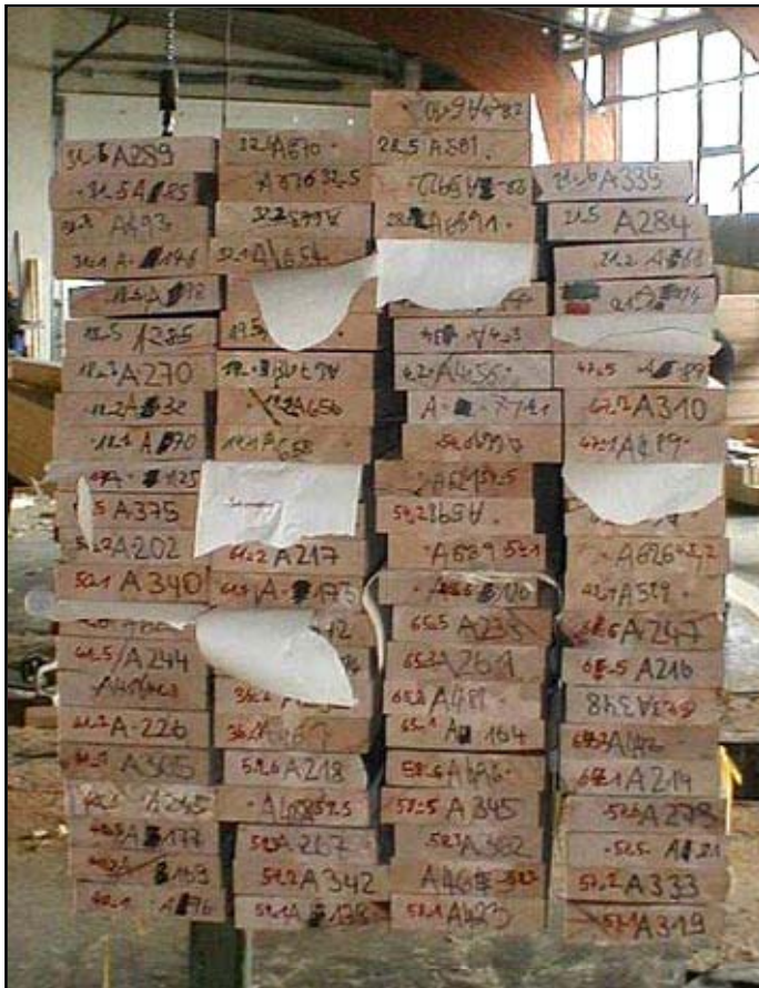
Abbildung 5.12: Zusammenlegung der Lamellen zu Trägern im Werk
