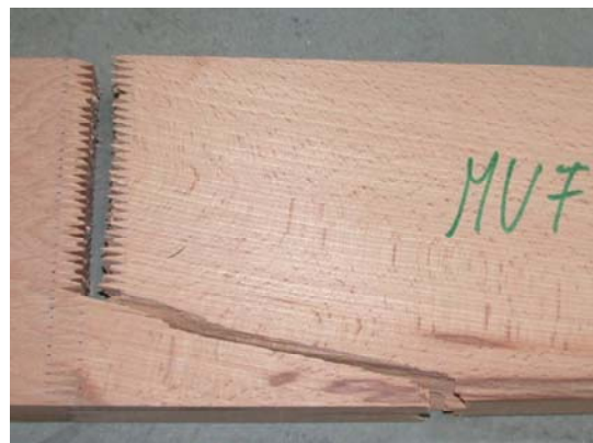
Abbildung 6.45: Teilversagen der Keilzinkenverbindung
