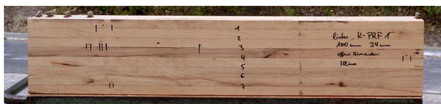
Abbildung 6.16: Balkenabschnitte aus der Klimakammer mit Messelektroden (offene Hirnenden)
