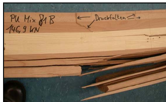
Abbildung 6.36: Erreichen der Maximallast unter starken Druckfalten
