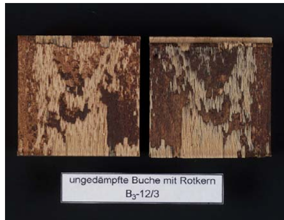
Querzugversuch 75% Holzbruch
