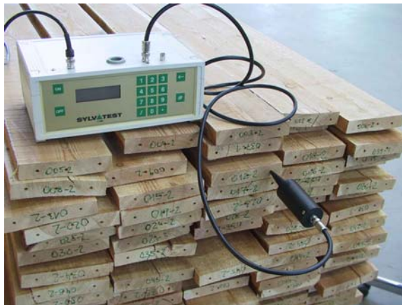
Abbildung 5.4: Ultraschallmessung (Bild von KATZENGRUBER, TU Graz, 2002)
