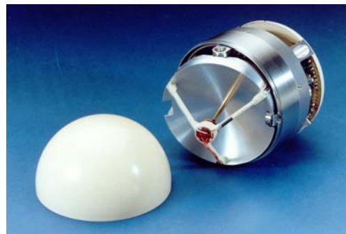
Flugprofil einer endphasengelenkten Munition und 94 GHz-Suchkopf
