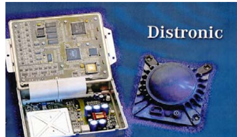
Anzeige der Distronic aus der Sicht des Fahrers und der Radarsensor mit Auswerteeinheit
