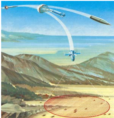
Flugprofil einer endphasengelenkten Munition und 94 GHz-Suchkopf
