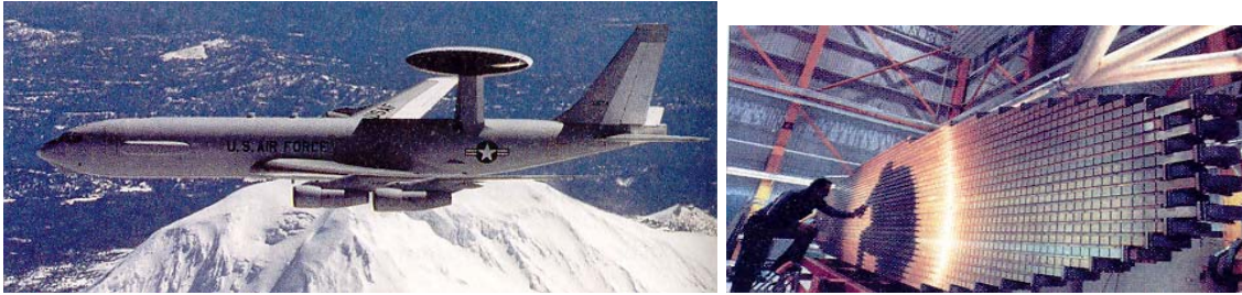
E-3A Sentry / AWACS und die Antenne des AN/APY-2 Radars
