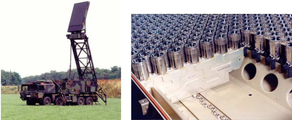
Mobiles Luftraumüberwachungs-Radar TRMS-3D und Ausschnitt aus dem Array
