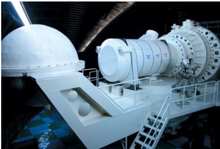
Оптический телескоп лазерного оптического локатора
