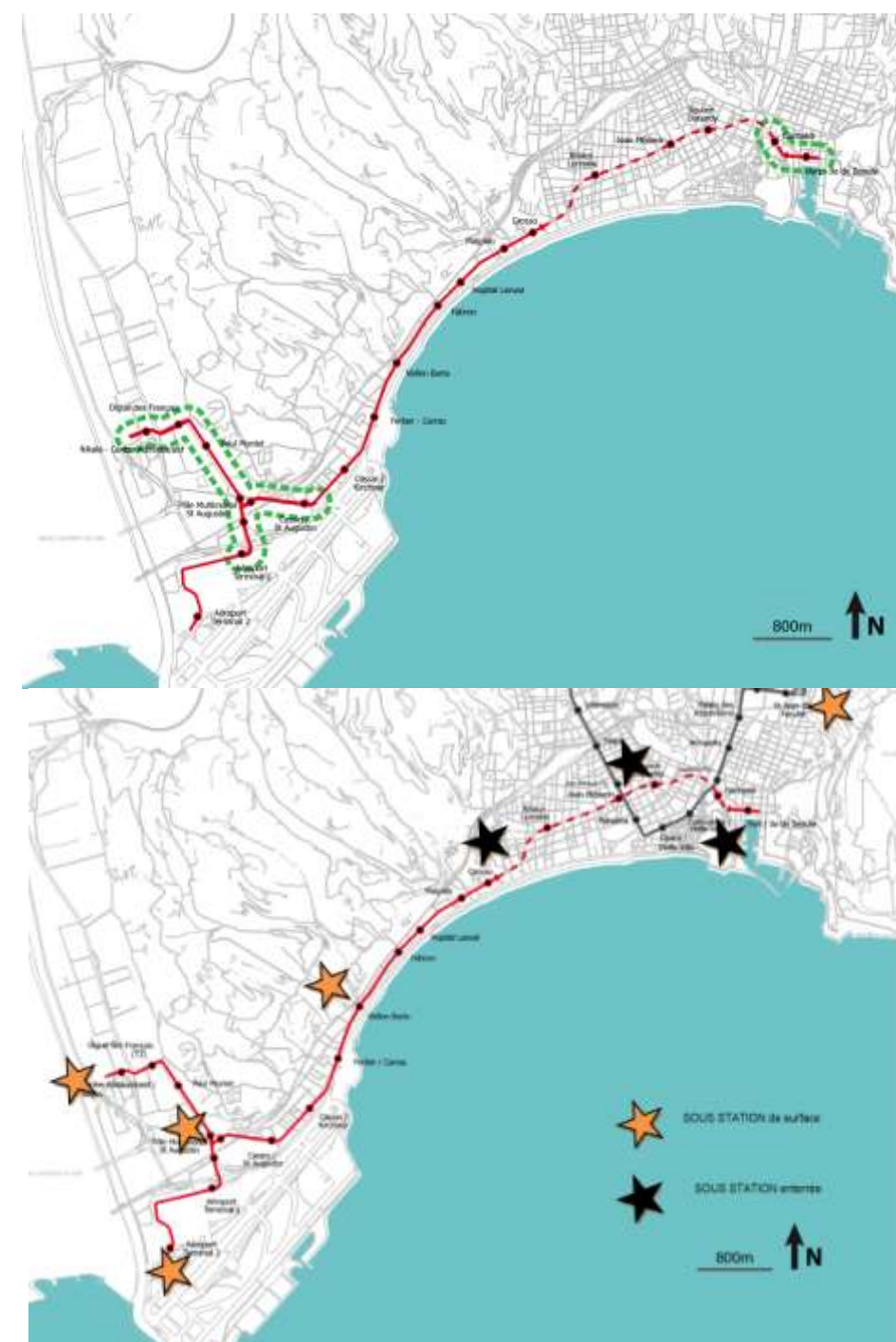
Figure 31 : Localisation de principe des sections avec alimentation électrique alternative à la LAC et des sous-stations
