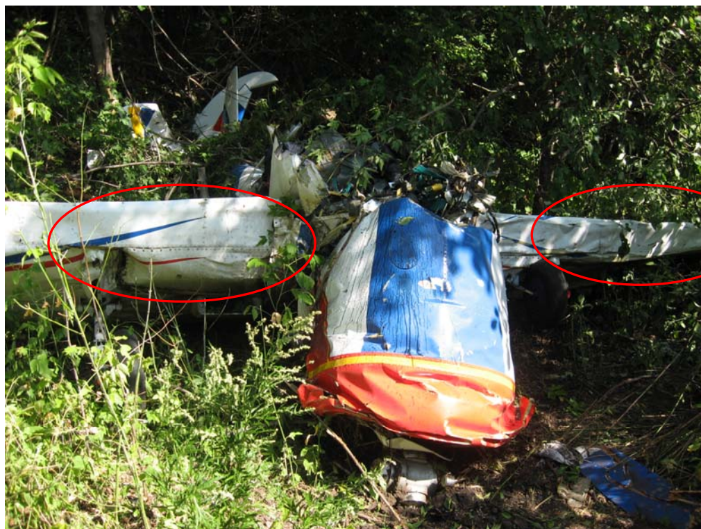
Фото 10. Деформированные передние кромки правого и левого полукрыла
