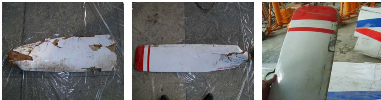
Фото 12. Лопасти воздушного винта после АП
