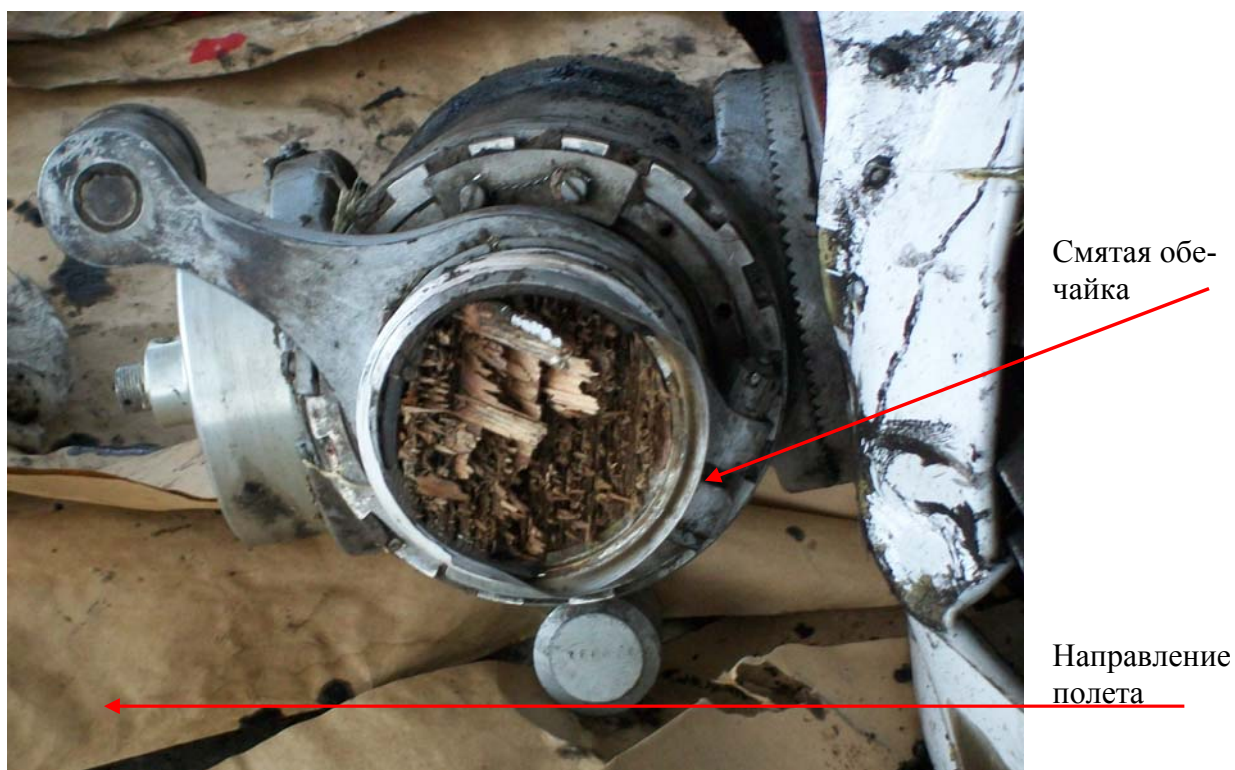
Фото 15. Место излома лопасти воздушного винта в комле
