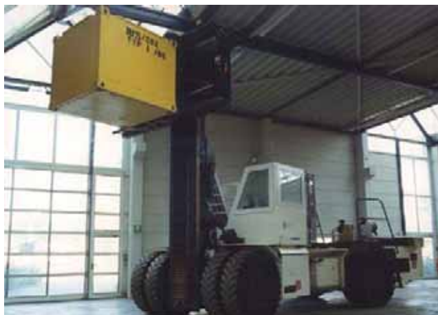
Figure 9.3.8 Chariot élévateur à contrepoids (photo DBE)
