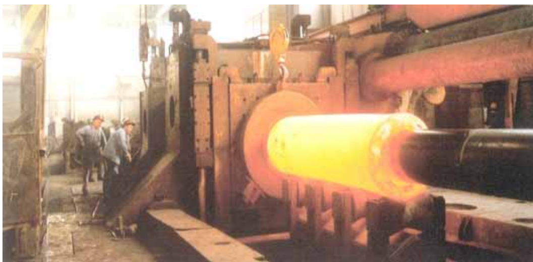
Figure 4.2.7 Opération d'étirage dans une filière à l'aide d'un mandrin et d'une presse horizontale
