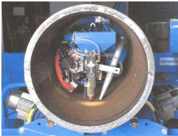
Figure 5.2.21 Robot soudeur pour souder à l'intérieur du chemisage (photo Air Liquide)
