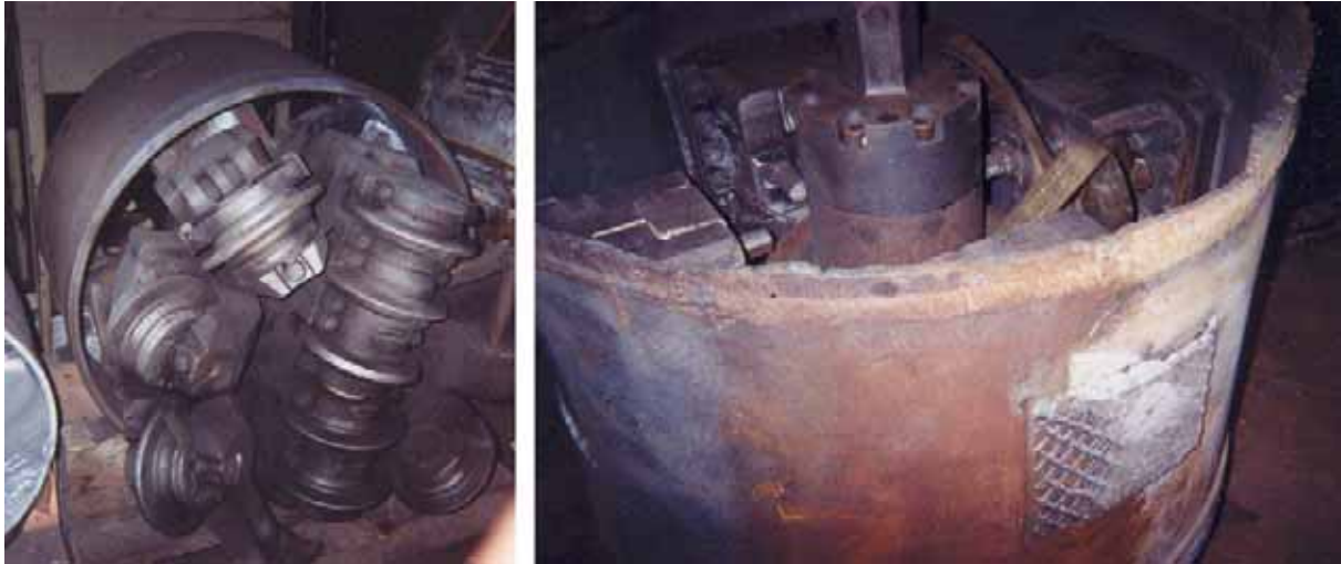
Figure 5.2.22 Tête de micro tunnelier (photos CREATIV ALLIANCE / matériel ROBBINS)
