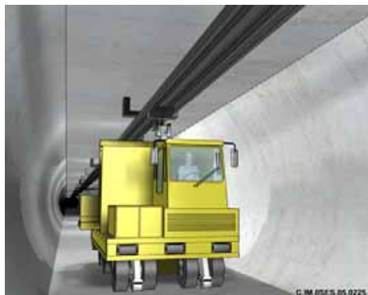
Figure 9.2.7 Véhicule de transfert d'une hotte de déchets B
