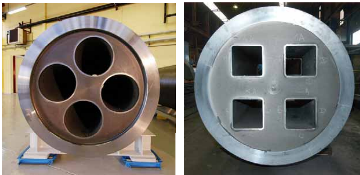
Figure 4.3.10 Les deux versions de conteneur de grand diamètre à logements cylindriques et carrés
