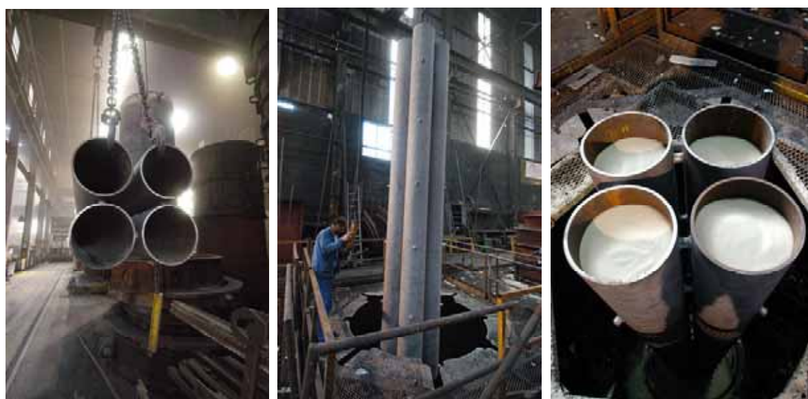
Figure 4.3.12 Préparation pour la coulée de l'insert
