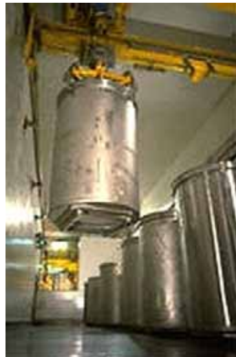
Figure 3.2.13 Fût en inox de 1 800 litres contenant des déchets de structure cimentés
