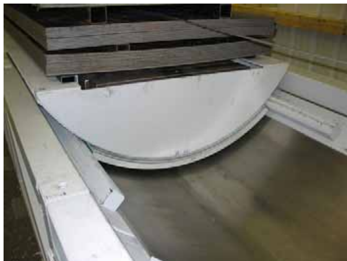
Figure 9.3.20 Test de translation par coussin d'air d'une charge simulant la forme et le poids d'un colis de stockage de combustible usé de type CUI
