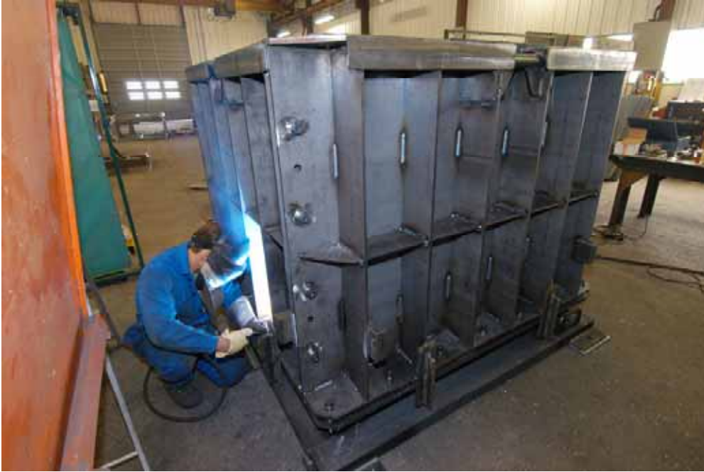
Figure 4.1.7 Moule du corps pour conteneur standard (B2)
