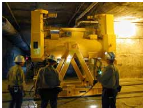
Figure 9.2.3 Hotte de transfert de colis de stockage (photo issue du WIPP)
