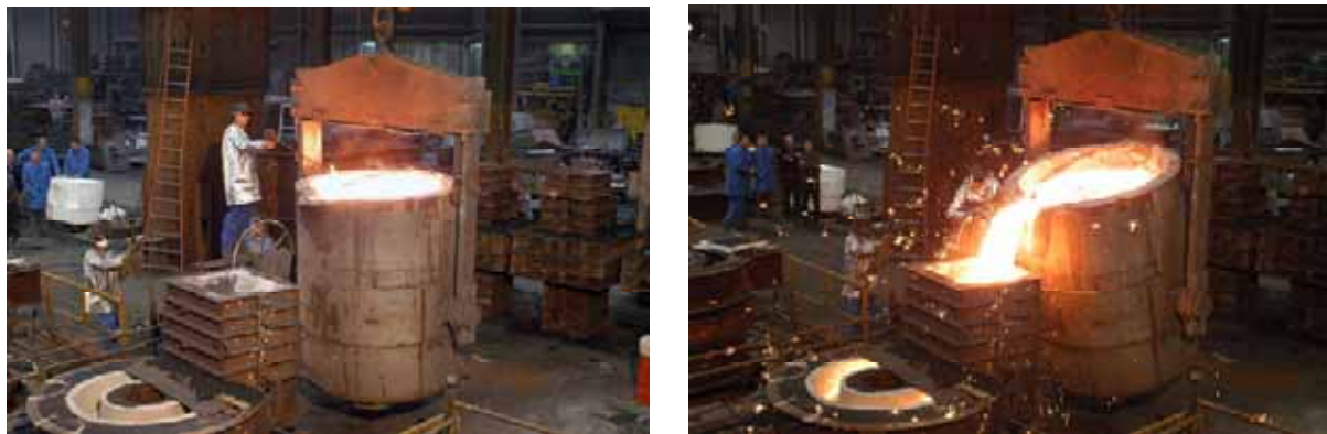
Figure 4.3.13 Coulée de l'insert
