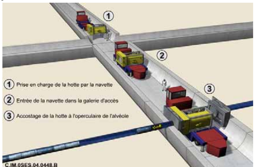
Figure 9.2.9 Accostage de la hotte C par la navette sur la tête d'alvéole
