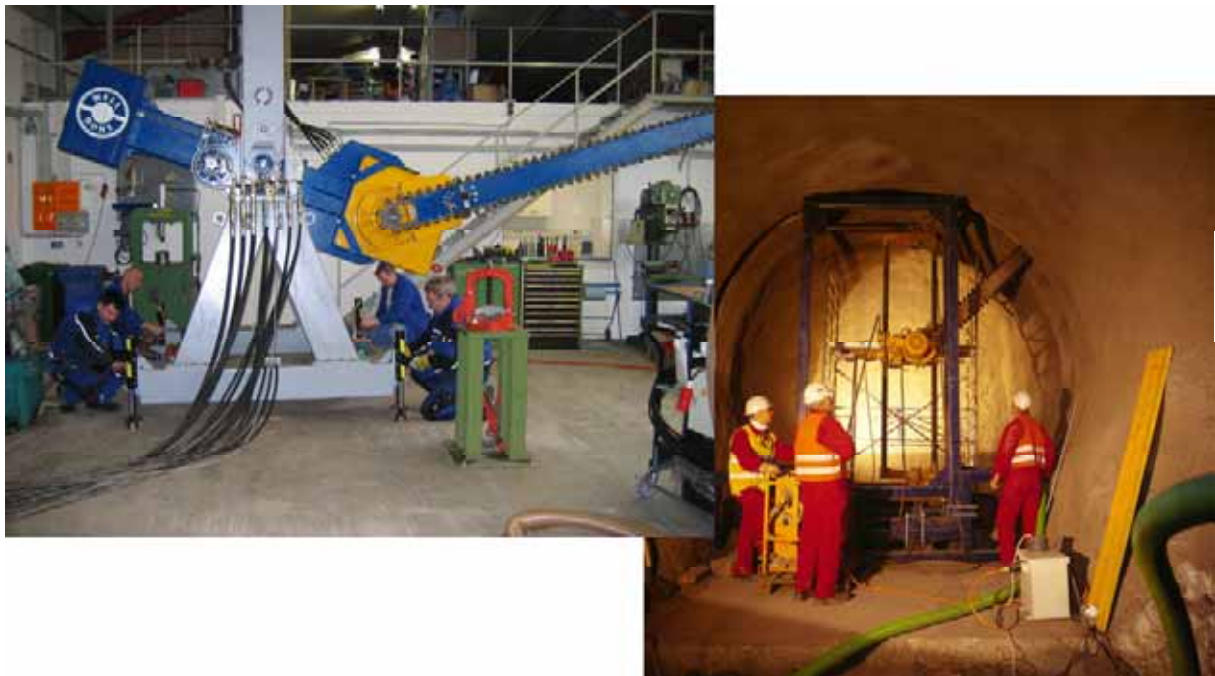
Figure 7.7.4 Scie construite pour l'essai KEY au laboratoire de Meuse/Haute Marne (à gauche) et essai EZ-A au laboratoire du Mont Terri (à droite)
