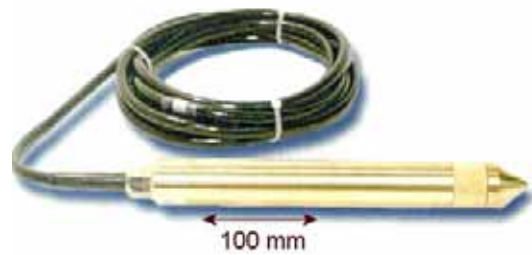
Figure 10.3.4 Cellule de pression interstitielle à corde vibrante
