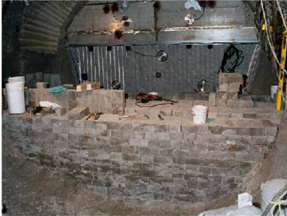
Figure 7.7.3 Scellement expérimental constitué de blocs de bentonite – essai TSX mené au Canada (à l'échelle industrielle, ces blocs seraient de dimensions supérieures)
