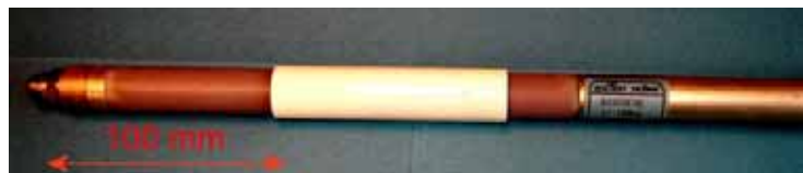
Figure 10.3.3 Extensomètre inductif de forage
