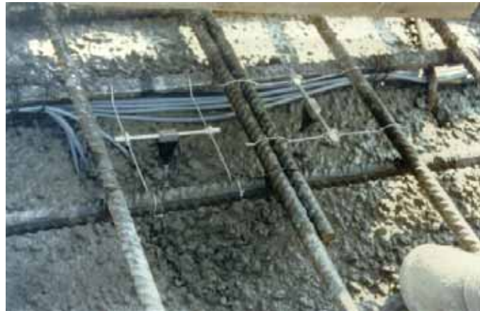
Figure 10.3.1 Illustration d'un extensomètre à corde vibrante, rattaché à une armature et intégré dans l'ouvrage en béton
