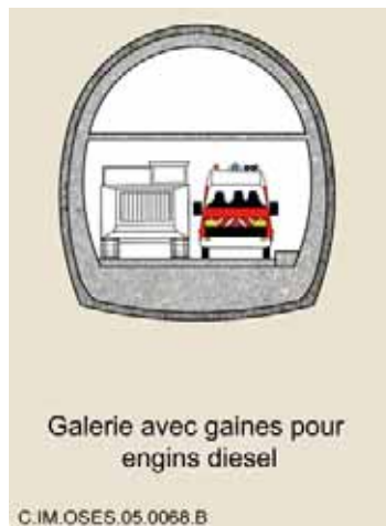
Figure 7.4.6 Galerie de travaux avec piste
