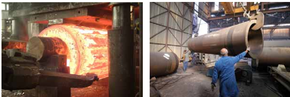
Figure 4.3.11 Etapes de la fabrication de la virole en acier non allié
