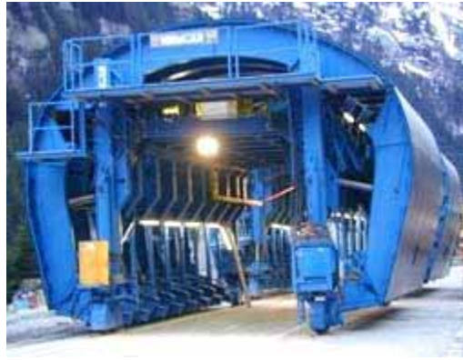
Figure 5.1.24 Coffrage mobile pour tunnel
