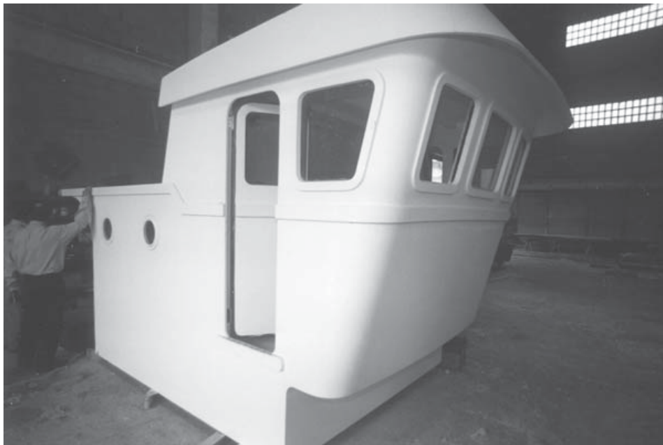
Figura 104.- Caseta en madera contrachapada construida en el Astillero Roseva de Canduas.
