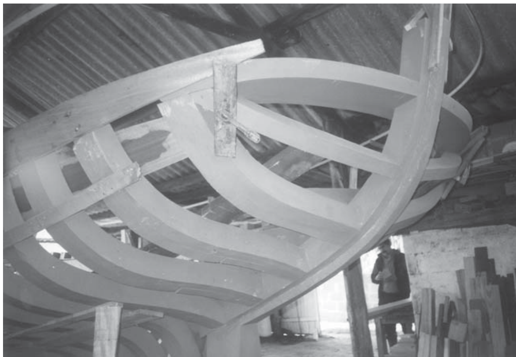
Figura 125.- Estructura de la popa de un barco de 10,70 metros de eslora total, en construcción en el astillero de César Loureiro Cintiana.
