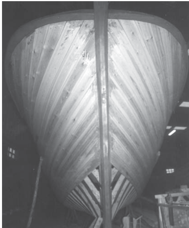
Figura 85.- Disposición de bances manteniendo el ancho.
