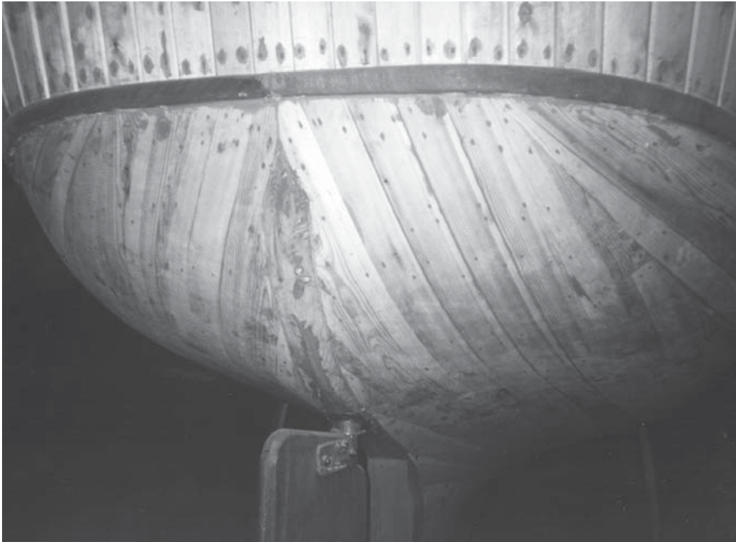
Figura 87.- Banceado manteniendo el ancho en la popa de parrulo . En la parte superior, se ha dispuesto una franja de entablillado vertical para evitar bances de excesiva curvatura.
