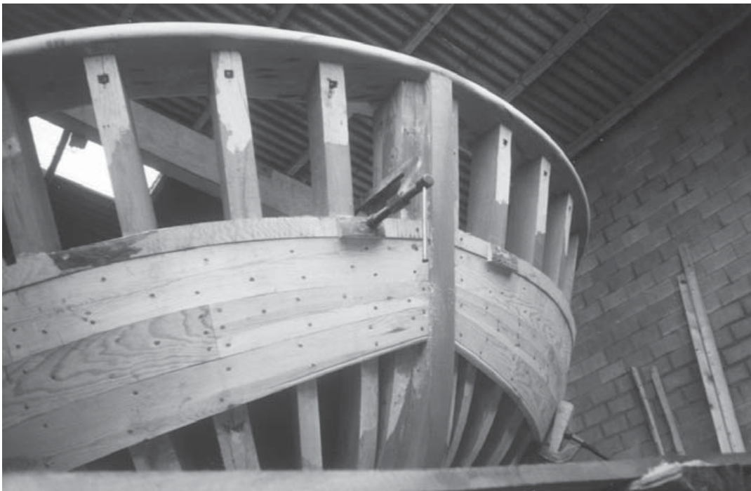
Figura 88.- Disposición de bances a hilada en una popa de parrulo .
