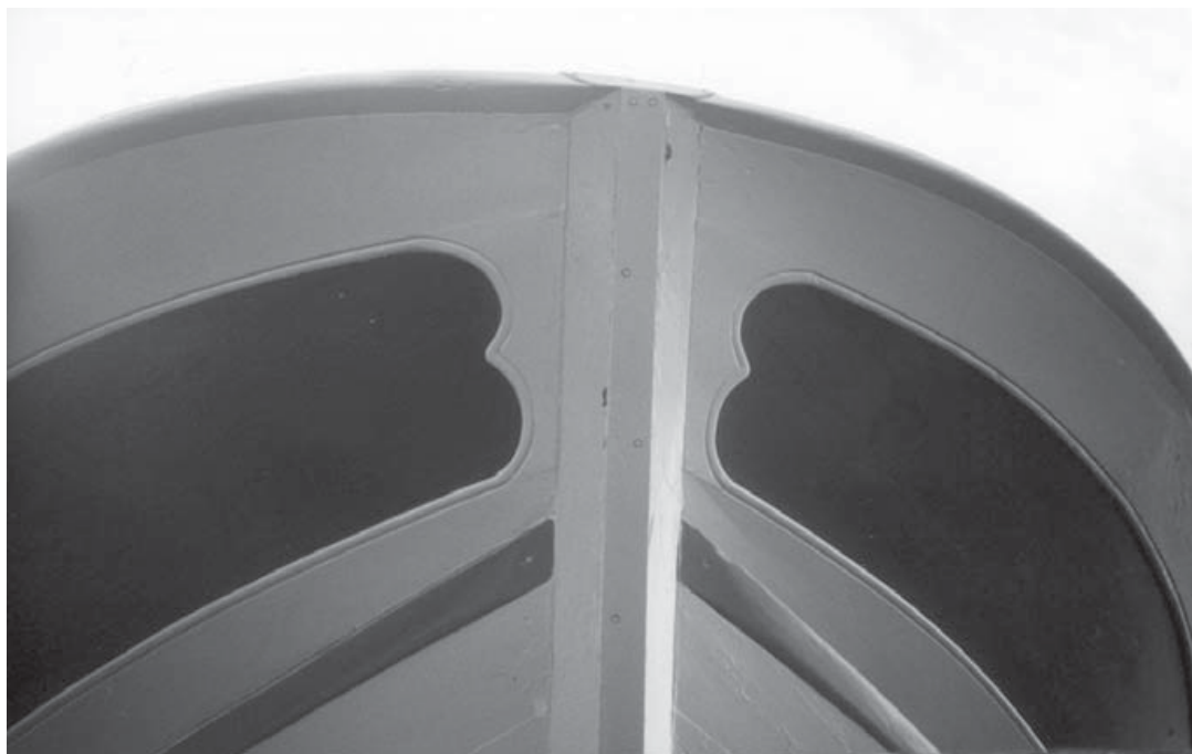
Figura 95.- Remate del fondo de la obra muerta en proa, distintivo de Astilleros Abuín de Rianxo.
