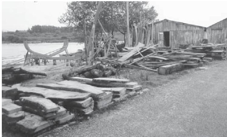
Figura 117.- Roda, quilla y primeras cuadernas del pesquero «Nuevo Luz» construido en 1988 por Francisco Fra Ponte para el armador Ramón Pérez Rodríguez.
