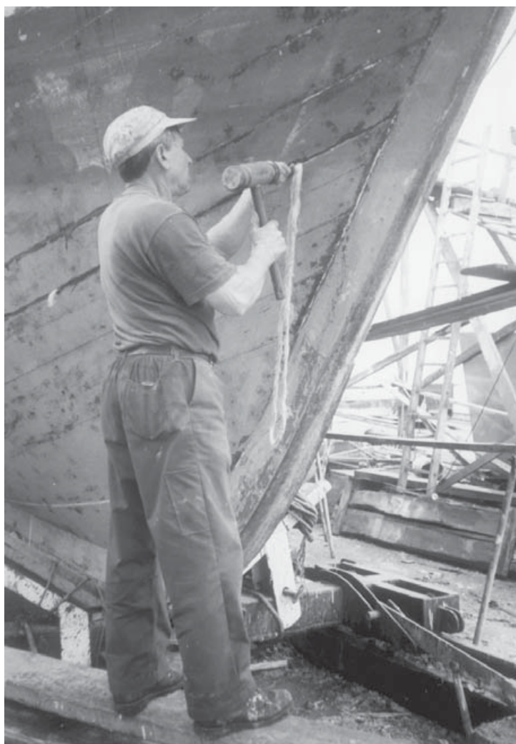
Figura 5.- Calafateando las costuras de proa de un pesquero en reparación en el Astillero Hermanos Suárez Taboada S.L., en A Cabana. A Coruña.
