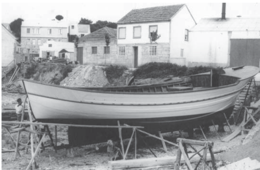
Figura 139.- Pesquero «Vázquez Mena» de 15,00 metros de quilla, 4,40 de manga y 1,80 de puntal, construido por José Abuín Alcalde en la primitiva ubicación del astillero.
