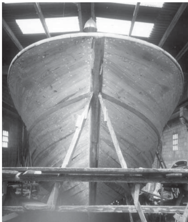
Figura 86.- Disposición de bances a hilada.
