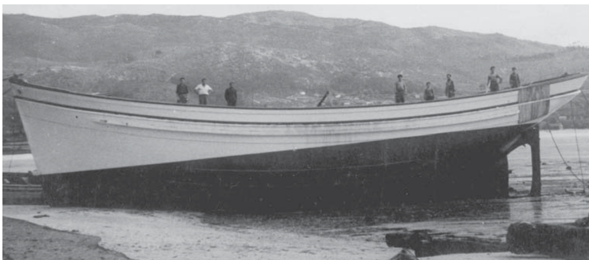
Figura 155.- El « Coneso » construido en 1948, varado después de la botadura. En el costado de la zona de popa se distingue la defensa dispuesta para proteger el forro del arte en la zona de recogida. Se trata de una baka.
