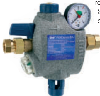
► Abb. 3: Systemtrenner Typ CA: Diese für Deutschland neue Armatur wurde in die DIN EN 1717 aufgenommen und ist für Anwendungen bis zur Flüssigkeitskategorie 3 einsetzbar.
