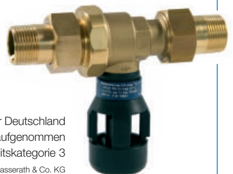
▼ Abb. 2: Beispiel für eine normgerechte Absicherung des Trinkwassernetzes gegenüber einer Heizungsanlage. Die Kombiarmatur verfügt neben dem Systemtrenner BA zur festen Verbindung mit der Trinkwasserinstallation über Absperrung, Druckminderer und Manometer. Somit bieten sie zuverlässigen Schutz vor gefährlichen Flüssigkeiten im Trinkwasser sowie vor Schäden durch Überdruck.
