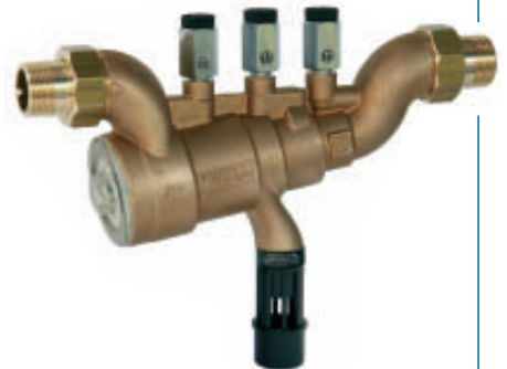
▼ Abb. 2: Beispiel für eine normgerechte Absicherung des Trinkwassernetzes gegenüber einer Heizungsanlage. Die Kombiarmatur verfügt neben dem Systemtrenner BA zur festen Verbindung mit der Trinkwasserinstallation über Absperrung, Druckminderer und Manometer. Somit bieten sie zuverlässigen Schutz vor gefährlichen Flüssigkeiten im Trinkwasser sowie vor Schäden durch Überdruck.
