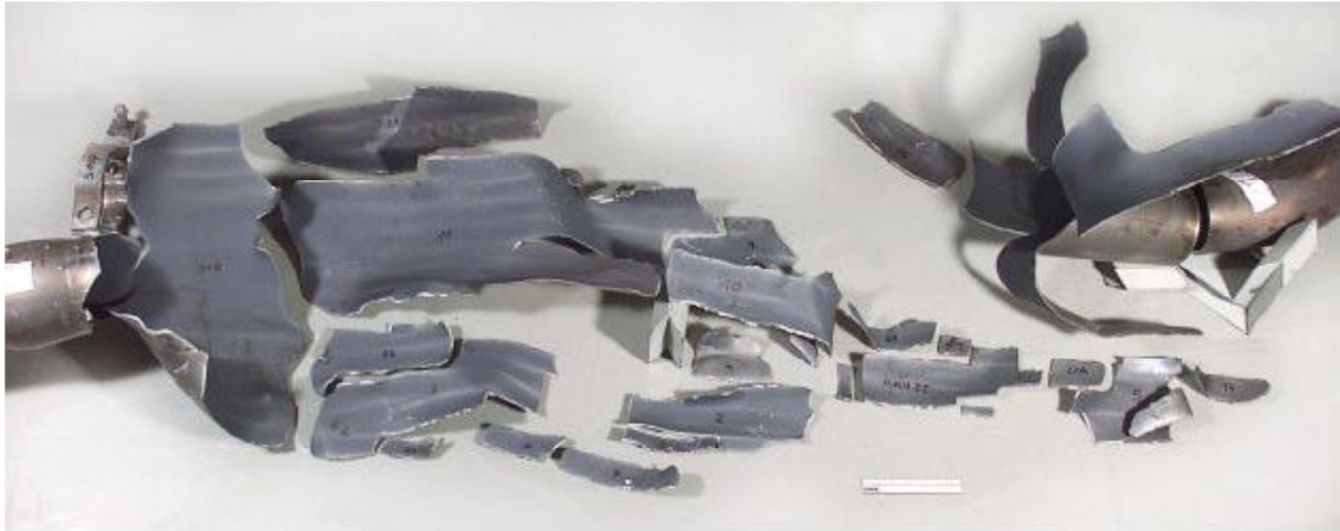
Abbildung 3.1.2: Bruchstücke der Deckelsprühleitung [KLEEN 2004]
