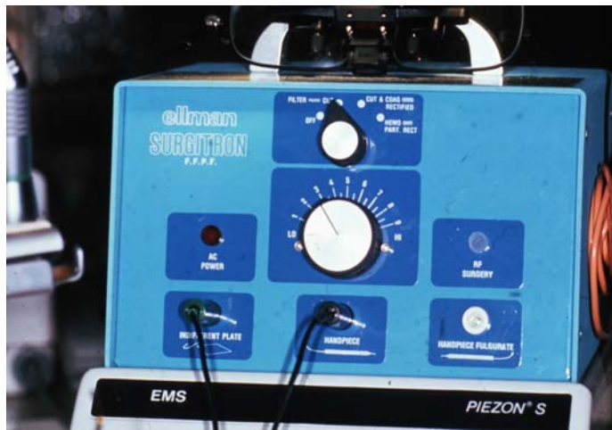
Das Surgitron Radiochirurgiegerät der Fa. Ellman mit 3,8 MHz
