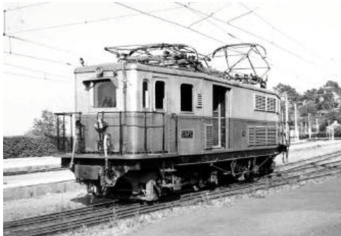
Locomotora eléctrica construida por GANZ para la Compañía General de Ferrocarriles Catalanes.
