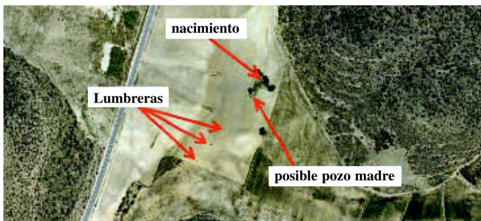
**Foto 2.2.1.** Fotografía aérea del nacimiento y primeras lumbreras del sistema de la galería con lumbreras de Las Tobarrillas. Producciones cartográficas de la Región de Murcia - Consejería de Medio Ambiente y Ordenación del Territorio. Escala 1: 5000 (Año 2002).
