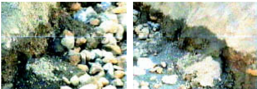
Foto 44. Corte de los depósitos de arenas y gravas en la Rambla de Nogalte, observándose la capa seca superior y la capa saturada inferior.
