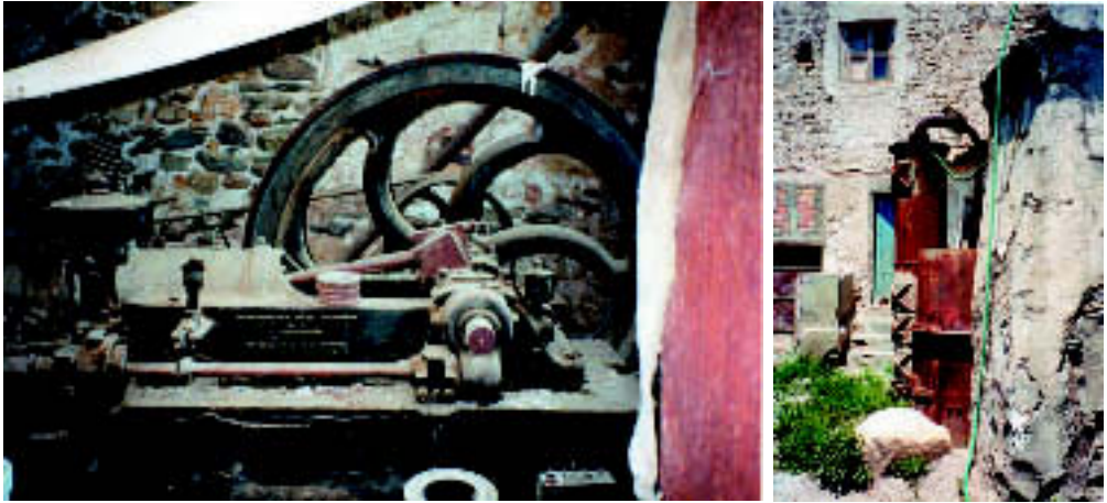
FOTO 15. Los motores de gas pobre para el movimiento de la maquinaria de molinos y almazaras.
