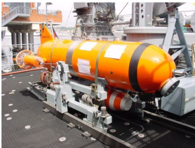
Fig. 4 – ROV Penguin B3. Desactivación de minas.
