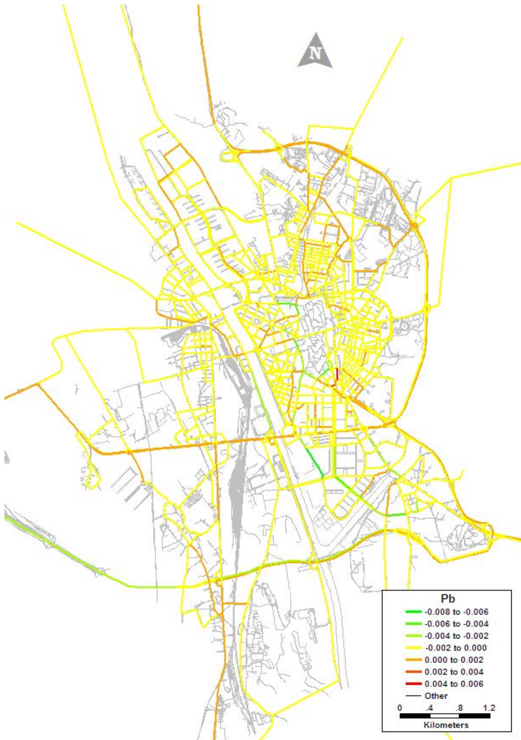
FIGURA A5.20. REDUCCIÓN DE EMISIONES (GRAMOS) DE PLOMO COMO CONSECUENCIA DE LA PUESTA EN SERVICIO DEL TRANVÍA
