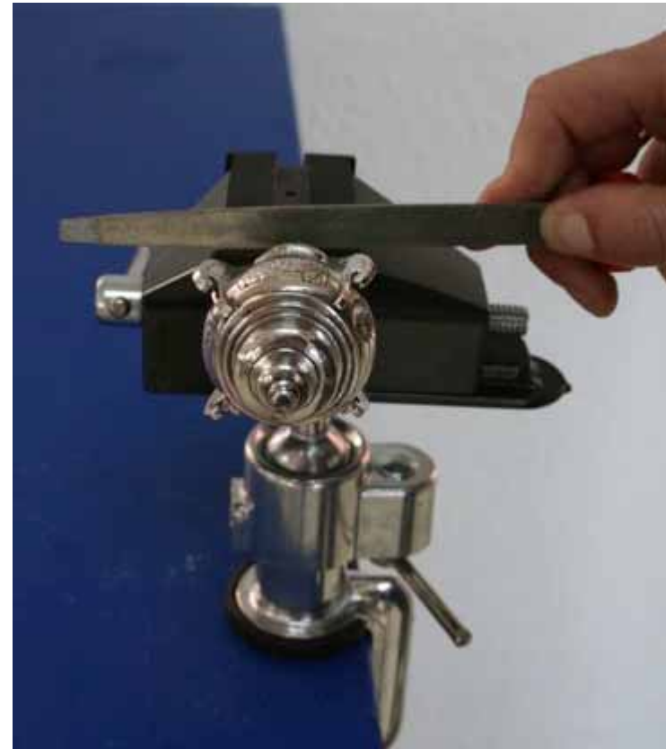
Tratamiento de lijado y ajuste del nuevo anclaje
