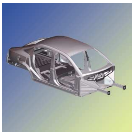
Программа создания сверхлегких, высокопрочных стальных корпусов (Ultralight steel Auto Body, ULSAB)
