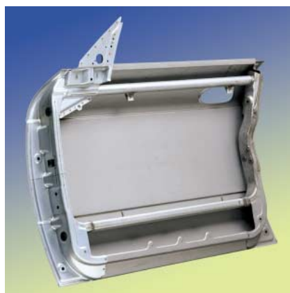
Программа создания ультралегких стальных дверей и капотов (Ultralight Steel Auto Closure, ULSAC)
