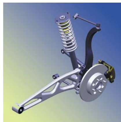
Программа создания ультралегких стальных систем подвески (Ultralight Steel Auto Suspensions, ULSAS)
