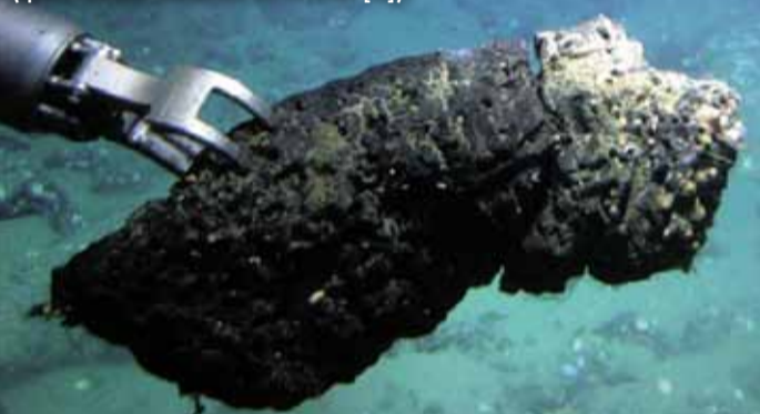
Рис. 1. Образец асфальтовой лавы с одного из изученных асфальтовых вулканов ( Il Duomo ). Образец отбирается манипулятором с подводного аппарата Alvin (фото заимствовано из статьи [4]).
