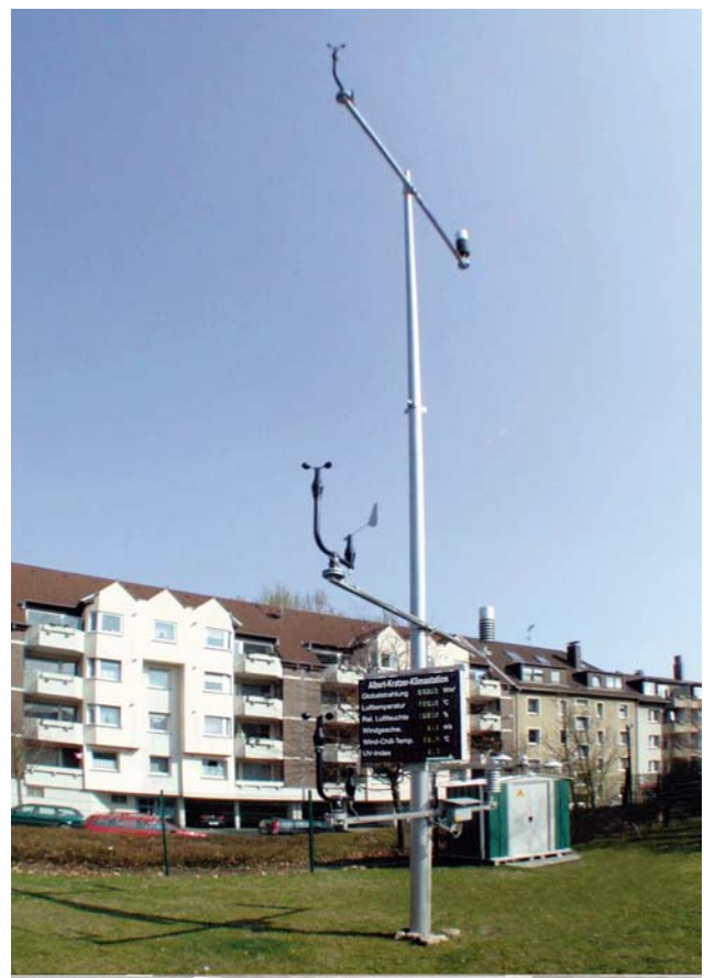
Abb. 2-2: Umweltmeteorologische Messstation zur Erfassung der Lufttemperatur, Luftfeuchtigkeit, des Windes und verschiedener Energiebilanzglieder in unterschiedlichen Messhöhen (Foto: Kuttler).
