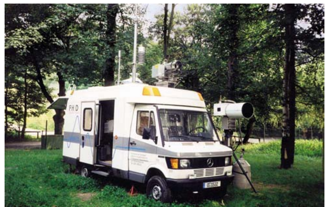
Abb. 2-6: Optische Fernerkundungssysteme DOAS (auf dem Fahrzeug) und FTIR (neben dem Fahrzeug) zur horizontalen Erfassung lufthygienischer Komponenten (vgl. Tab. 2-4) (Foto: Lamp).
