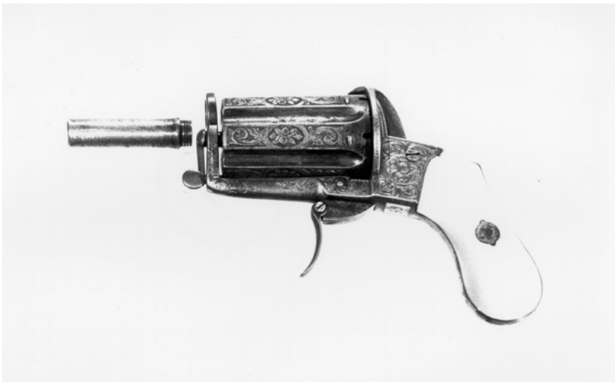
Una PAPPERBOX a spillo del 1865 circa, provvista di una canna (ad anima liscia, e quindi ben poco utile) avvitabile. Quasi sicuramente tale accorgimento era pensato per aggirare il divieto di pistole con canna inferiore ai mm. 171 (Collez. Mainini, Macerata)
