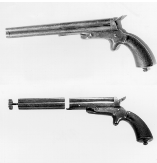
Una pistola firmata TOMMASO TONI (più esattamente è siglata TTR: sigla che va appunto letta come Tommaso Toni Roma ) dello stesso tipo della Sharps a quattro canne, ma dotata di una prolunga delle canne stesse, che consentiva quindi la detenzione ed il porto di tale arma, in rispetto dell'art. 455 C.P. suddetto. La prolunga poteva, però, facilmente essere tolta e l'arma riacquistava la sua occultabilità (e illiceità!!!) (Coll. Maggi, Montefano)
