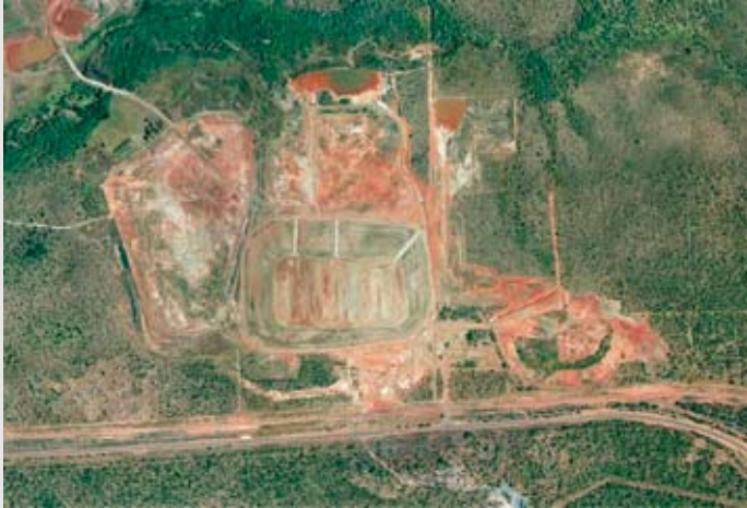
Gambar 4: Lokasi tambang yang direhabilitasi pada tahun 2005, setelah pembangunan lapisan penutup di atas timbunan batuan sisa, dengan kegiatan revegetasi yang akan diselesaikan
