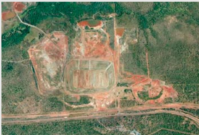
Hình 4. Công trình mỏ đã phục hồi vào năm 2005, sau khi xây dựng lớp bao phủ cho đồng đá thải, nhưng hệ thực vật còn cần hoàn chỉnh
