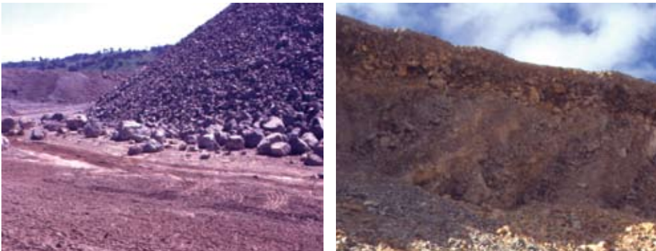
Hình 10: Lớp đá thô ở đáy (hình trái); lớp đá có góc nghỉ và bị nén (hình phải)
