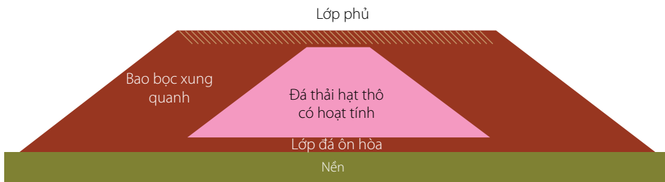
Hình 11: Bọc chất thải hạt thô có hoạt tính cao
