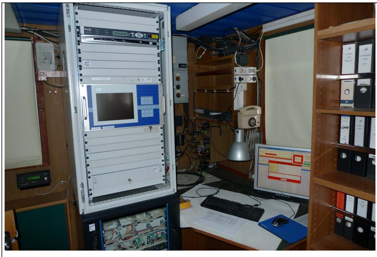
Abb.10.3.1: Der wissenschaftliche Arbeitsplatz im achteren Teil der Brücke; Im Reck: DShip master PC (Achtung: darf nur durch Brücke bedient werden), Tiefseelot 12 kHz (Achtung: darf nur durch die Brücke bedient werden!), Reiseassistent (IOW, Anzeige); hinten: GPS Geräte GG24 & ADU5, Versorgung GPS Geräte, ARGOS Peilgerät (GONIO, mobil); Antennenanschluss dazu aufgebaut; vorne: Bildschirm & Konsole DShip master (darf nur durch Brücke bedient werden)
