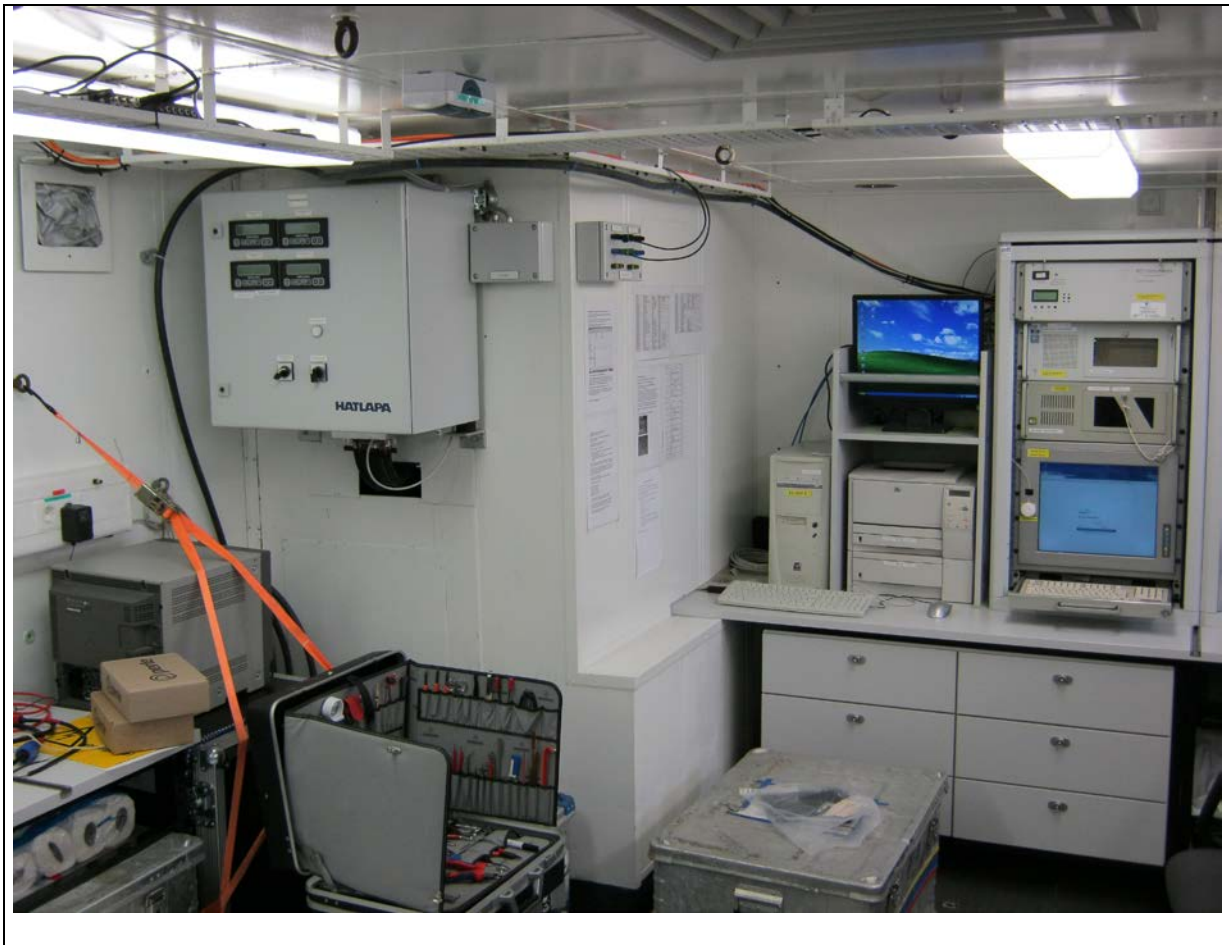
Abb. 10.5.3: Trockenlabor, Vorkante Bb., v. l. n. r.: (i) o. li. Kabeldurchführung zum Hauptgang (ii) li.: ADCP , 75 kHz, Bordgerät & Erfassung; (iii) a.d. Decke Video (iv) Netzwerkdrucker HP Laserjet 2300 dtn ; (v) DHCP Server und e-mail Rechner ; darüber Dominator des Reiseassistenten des IOW;
