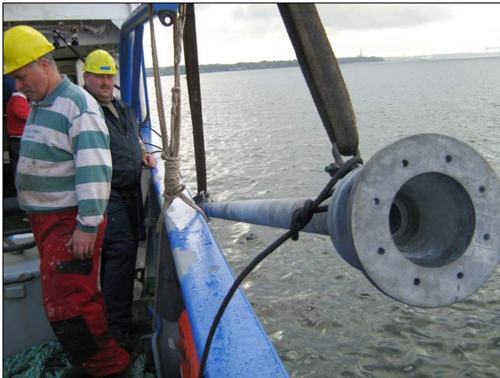
Abb. 16.9.1: unteres Ende des USBL Mastes, welcher in einem Vierlochflansch endet (hier nicht sichtbar). Es folgt ein Adapterstück, welches für ein spezielles Hydrophon mit einem Flansch mit acht Löchern abschließt. Rohr und Flansche sind von innen hohl, so dass Versorgungs- und Datenkabel im Inneren Platz finden. S. Abb. 16.9.2 für die Maße des 4-Loch Flansches am Ende des Mastes, der die jeweiligen Adapter aufnimmt.
