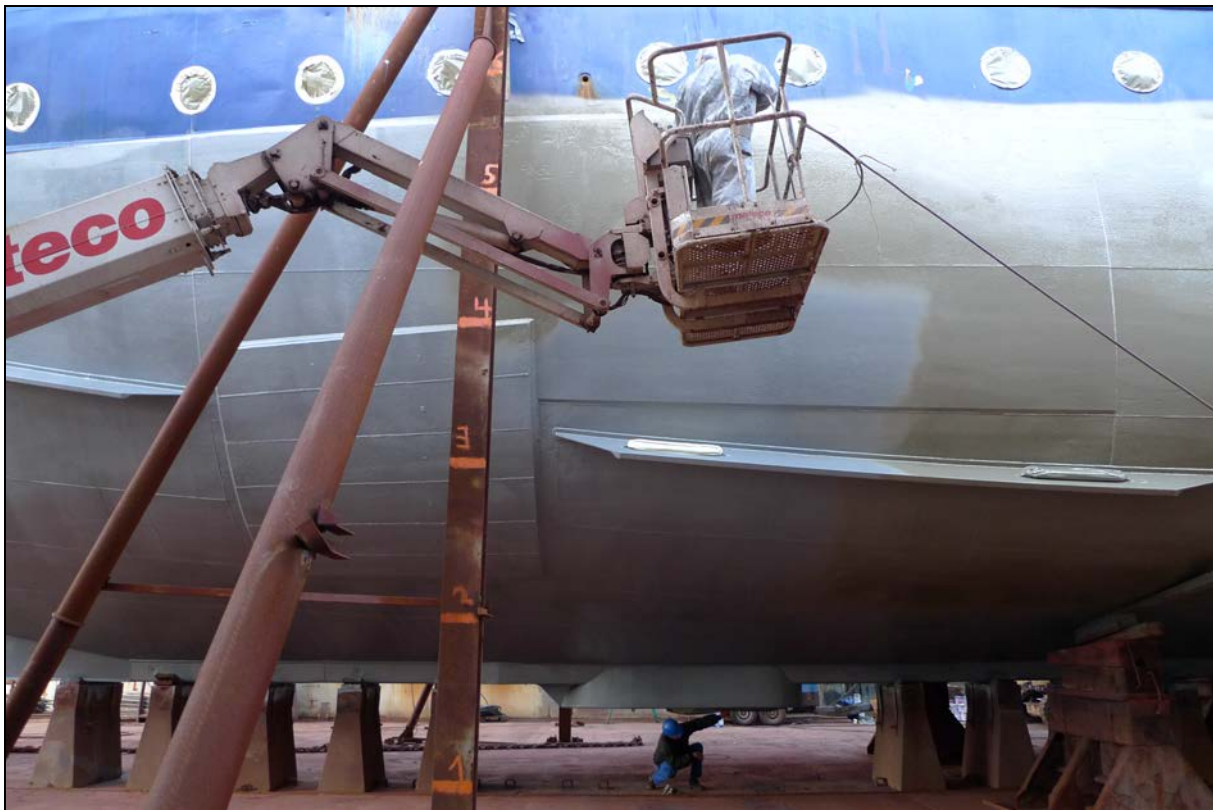
Abb. 11.5.1: POSEIDON 2011 im Dock; unter dem Kastenkiel die Kammer für die Schwinger des Fächerlotes von L3-ELAC
