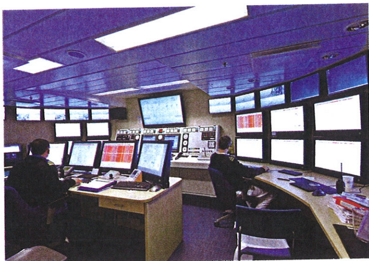
ALAKANSILLA sijaitsevassa koneautomaation ohjaushuoneessa tarkkaillaan moottorien ja generaattorien toimintaa sekä tarvittaessa hienosäädetään moottorien keskinäistä kuormitusta.
