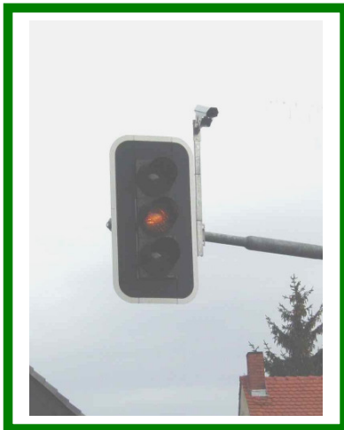
Bild 62a: Videokamera am Ausleger zur Fahrzeug-erfassung (Fern-detektion) (BOSSERHOFF 2006)
