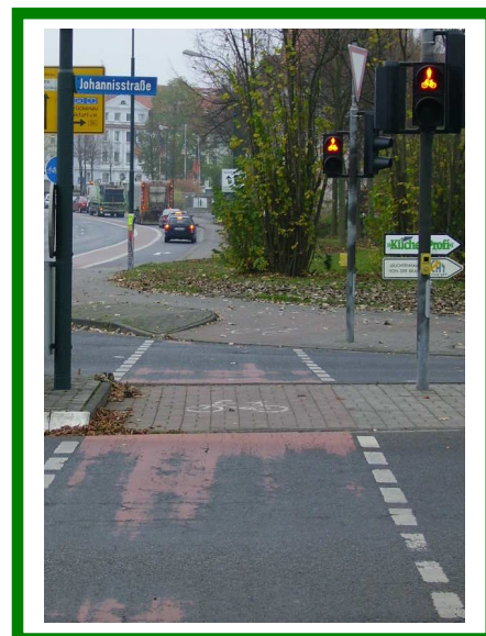
Bild 84: Gemeinsame Signalisierung für Fußgänger und Radfahrer (Foto: R. HERZIG 2006)
