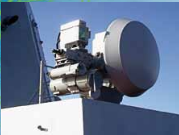
Dirección de tiro DORNA, de diseño nacional, instalada en las Fragatas Clase Álvaro de Bazán.
