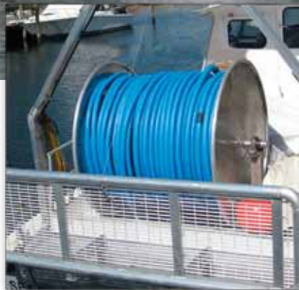
Kabel met geluidsmeter (streamer) Cable with sound meter (streamer)
