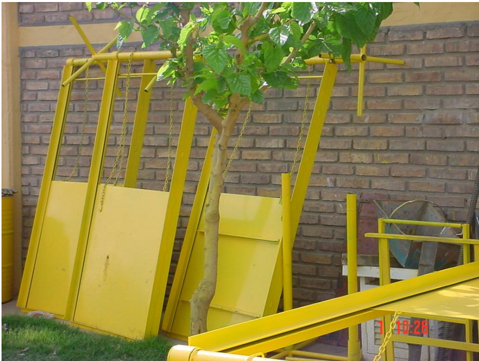
Compuertas fabricadas en las instalaciones de la Inspección de Cauce.
