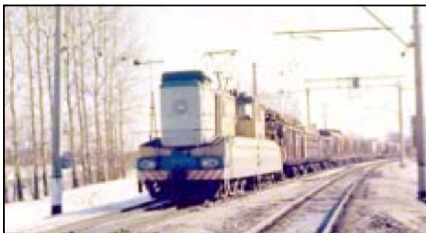
В 1970-ые года контактно-аккумуляторные электровозы серии ВЛ26 (один из экспонатов) работали не только на маневрах! Фото из коллекции Т. Алтбергса
