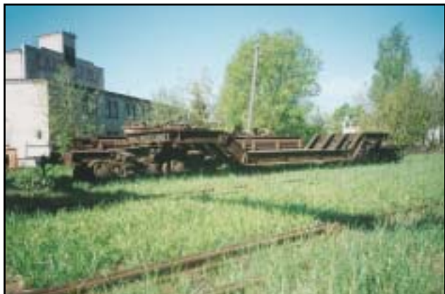
8-осный транспортер (тара 14,5 тонн, грузоподъемность 38 тонн)
