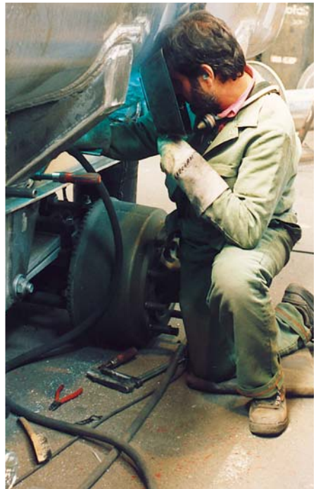
Bild 5-4: Personenbezogene Messung mit PAS für die Ermittlung partikelförmiger Schadstoffe
