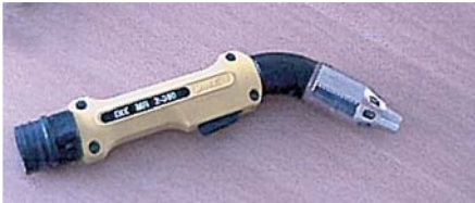
Bild 9-10: Brenner mit integrierter Absaugung
