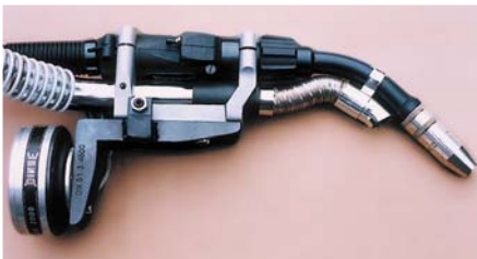
Bild 9-12: Brenner zum Metall-Schutzgasschweißen (MIG/MAG) mit integrierter Absaugung für automatisierte Anlagen
