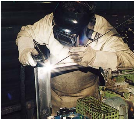
Bild 9-2: WIG-Schweißen, ein schweißraucharmes Verfahren
