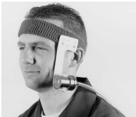
Bild 5-6: Schweißer, der eine am Sportler-Stirnband befestigte Probenahme-einrichtung trägt
