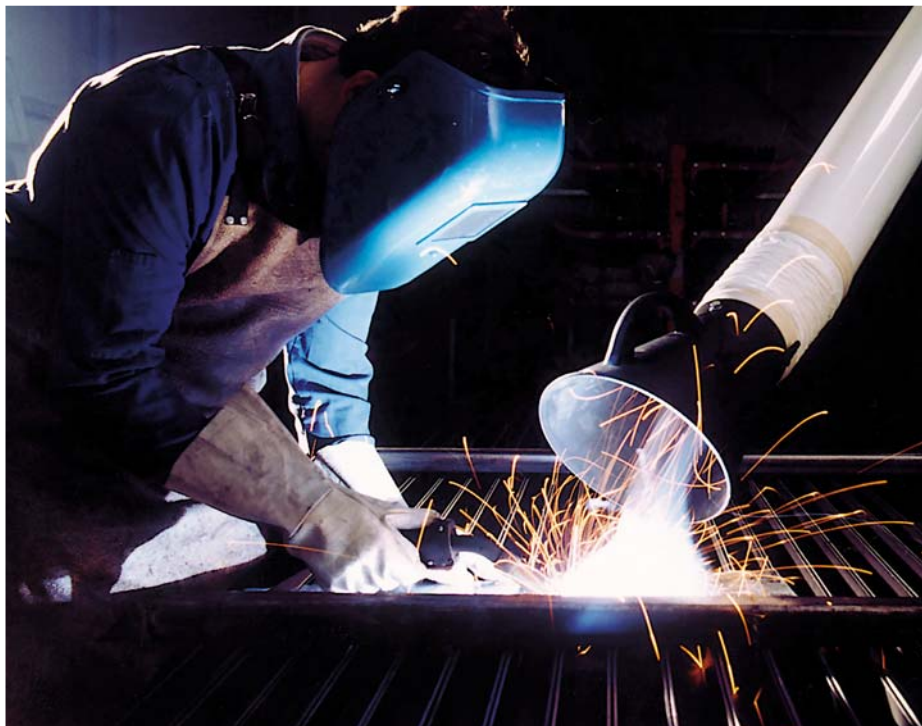
Bild 9-7: Metall-Schutzgasschweißen (MIG/MAG) mit Absaugung
