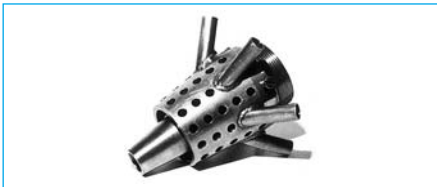
Bild 9-11: Arbeitskopfigintegrierte Absaugung für Nd:YAG-Laser
