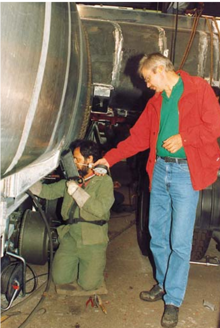
Bild 5-3: Messung von partikelförmigen Schadstoffen mit Hilfe eines personenbezogenen Staubsammelgerätes (PAS) sowie Prüfung auf gasförmige Schadstoffe mit Hilfe von Prüfröhrchen
