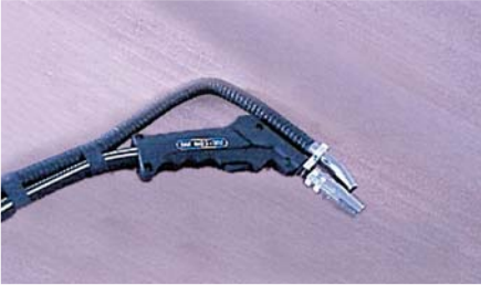
Bild 9-9: Erfassungselement am Brenner befestigt
