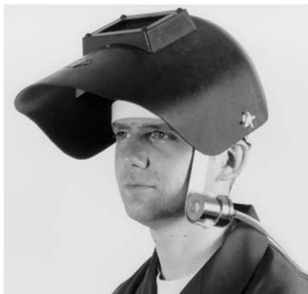
Bild 5-7: Schweißer, der eine am Sportler-Stirnband befestigte Probenahme-einrichtung und einen Schweißer-Gesichtsschutzschirm trägt
