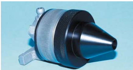
Bild 5-9: Zerlegter Probenahmekopf PGP-EA (Quelle: BGIA)
