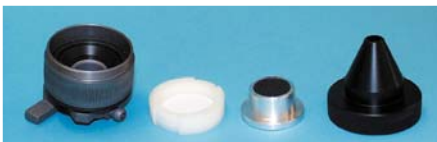
Bild 5-9: Zerlegter Probenahmekopf PGP-EA (Quelle: BGIA)
