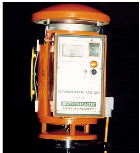
Bild 5-10: Stationäres Staubsammelgerät (VC 25) für die ortsfeste Probenahme (Messung) partikelförmiger Schadstoffe
