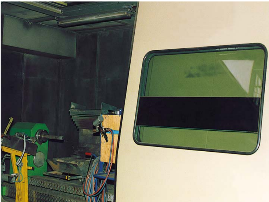
Bild 9-5: Geschlossene Kabine zum Plasmaspritzen
