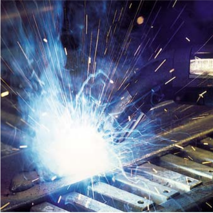
Bild 9-13 a: Brennerintegrierte Absaugung nicht in Betrieb
