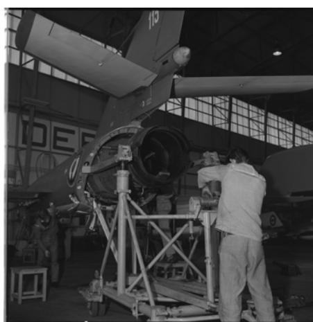
◆ n°11. Référence : REP1971-BANLA-031-0011 Dépose du réacteur d'un Étendard IV P. Landivisiau, 25 mars 1971, photographe Creskens ECPAD / Collection BAN Landivisiau
