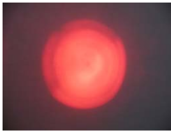
Lys fra en enkelt rå LED uden mikrolinseelement. Den ujævne lysfordeling hidrører fra diodens asymmetriske opbygning.
