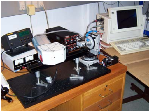
Foto af test stand: Test stand med LED holder (til højre) og spektrometer (til venstre).
