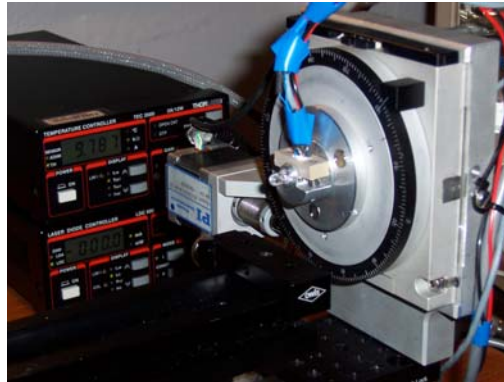
Foto af LED holder: Øverste halvdel af LED holderen. To stepmotor kontrollerer rotationen omkring to akser. LED strøm-forsyningen og temperatur kontrolenheden ses i baggrunden.
